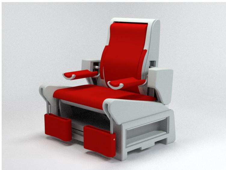
Figura 67: Principali superfici di appoggio e supporto, evidenziate in rosso
