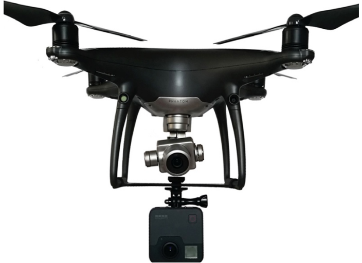
Figura 1 – UAV e camera sferica utilizzata nei test.
