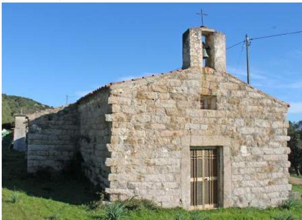
**Fig. 65** Chiesa campestre dalle forme semplici, muratura in granito a vista, copertura a due spioventi, campanile a vela sul timpano della facciata principale, contrafforti ai lati. Chiesa di San Bachisio (Santu Bâchisi), loc. *Baldu*, Tempio Pausania (OT). Foto dell'autore, 2013 (pre restauri 2017 che ne hanno alterato dei tratti originari)
