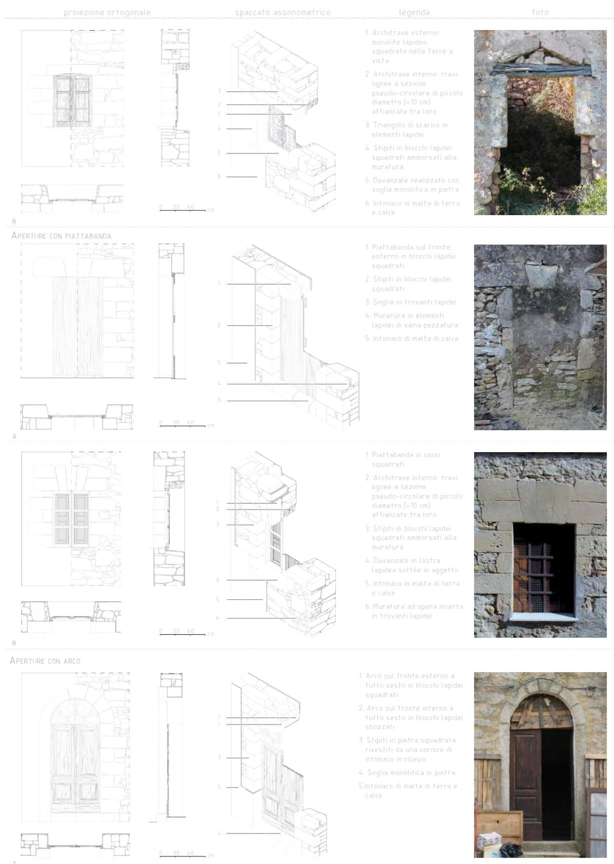
**Fig. 33.3** Abaco delle aperture, parte 3. (continua da Fig. 33.2) B finestra con triangolo di scarico; con piattabanda distinguibile in A ad una testa, B a due teste; con arco distinguibile in A porta con arco a tutto sesto.
