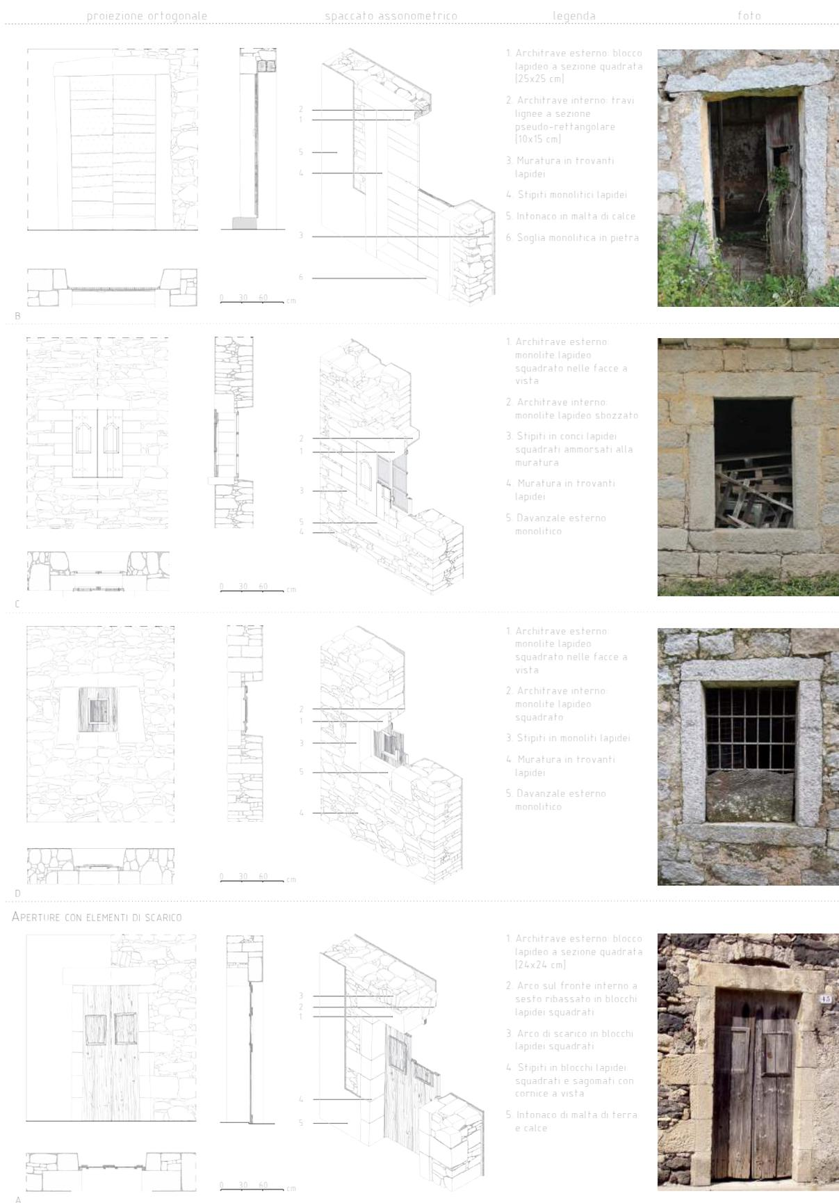
Le aperture realizzate con sistema strutturale pesante sono le più frequenti e possono avere architrave ligneo o lapideo ed essere sormontate o meno da elementi di scarico.
