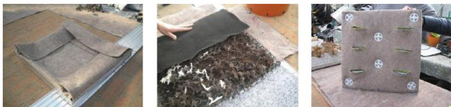
Figura 68 - Fasi di assemblaggio di un pannello.
