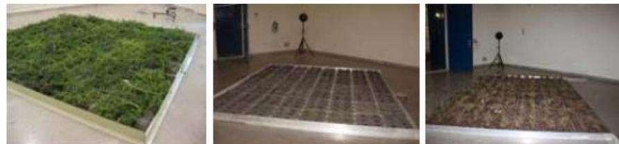
Figura 45 – Misurazioni in camera riverberante per i tre campioni di GMS.
