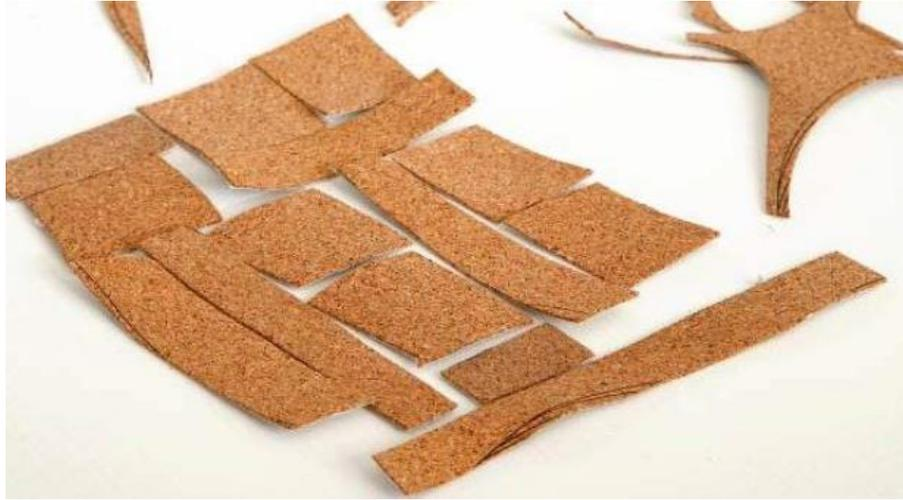
Figura 14 - Creazione componenti in sughero di forma regolare.
