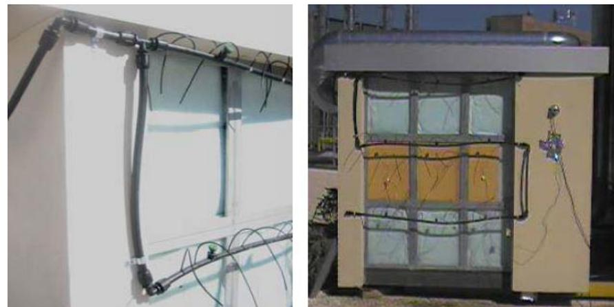
Figura 22 - Impianto di irrigazione del sistema GRE\_EN\_S.
