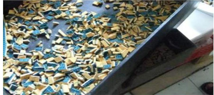
Figura 16 - Grani sminuzzati di microfibra in Poliestere e schiuma di Lattice spalmata.
