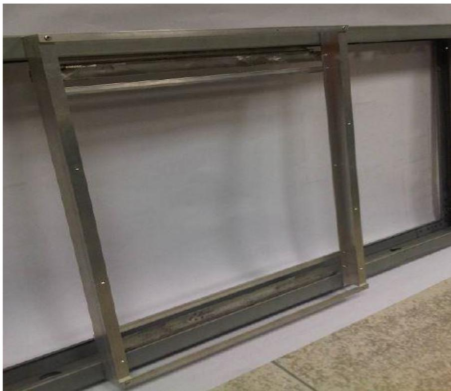
Figura 21 – Prova di aggancio del pannello Reviwall al sistema portante Bybox.
