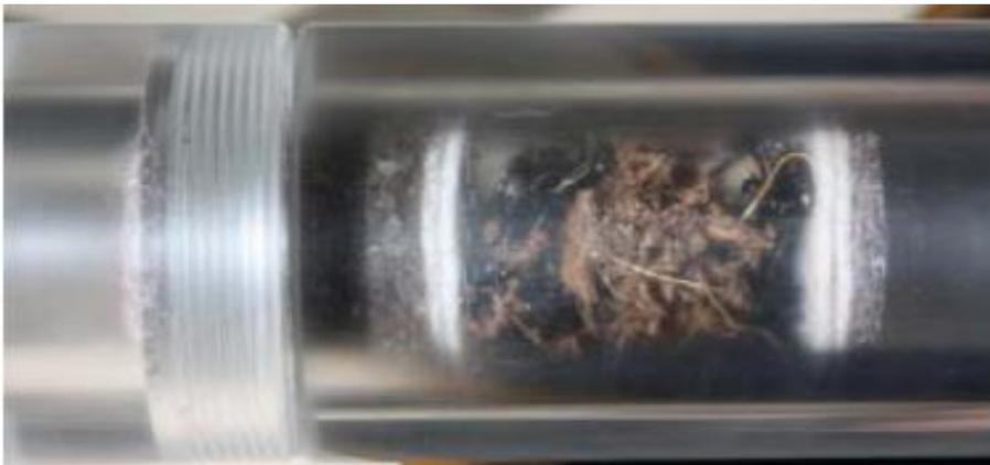
Figura 48 – Inserimento degli strati per le misurazioni nel tubo di Kundt.
