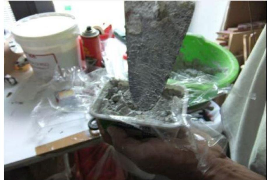
Figura 19 - Processo di formatura finale del pannello isolante.
