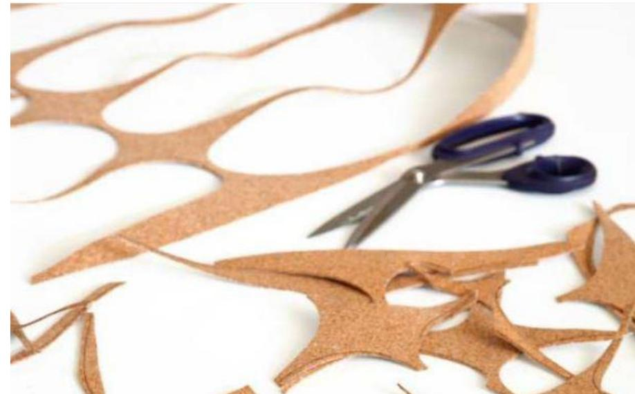
Figura 13 - Elaborazione dello scarto della produzione di solette per la realizzazione dei pannelli
