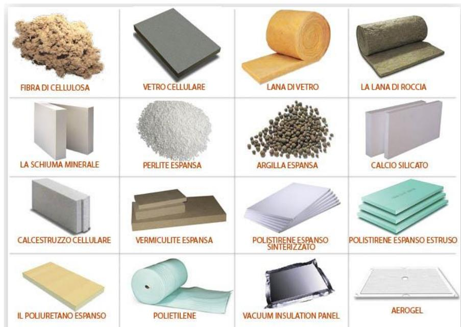
Figura 3 – Alcune tipologie di prodotti per l'isolamento termico (fonte: ristrutturazionaiello.it).
