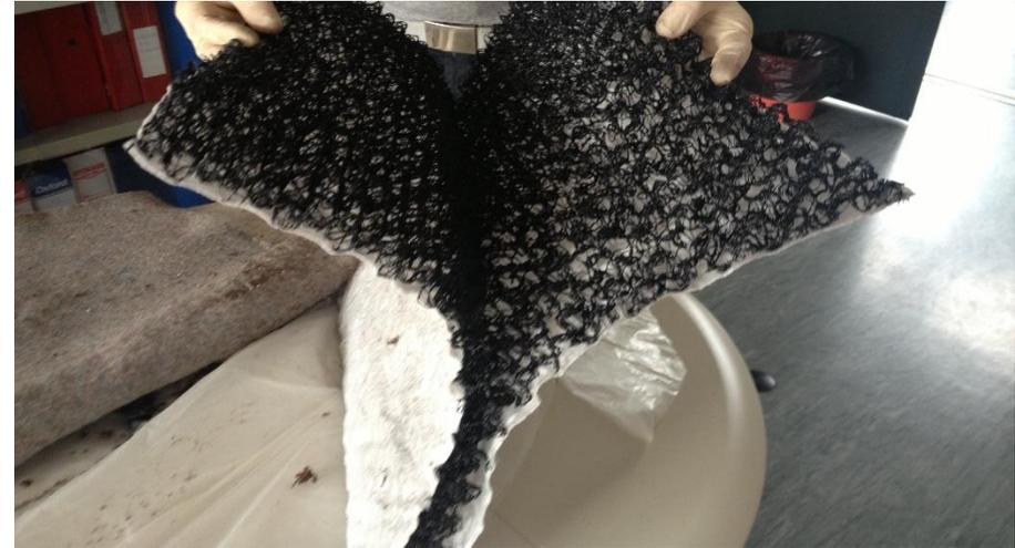
Figura 24 – Geogrid in filamenti di Polipropilene
