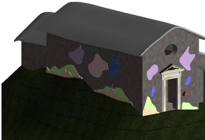
Figura 126 - Mappatura dei fenomeni di degrado sul modello
