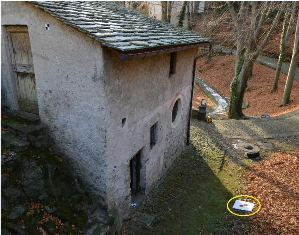
*Figura 22 - Marker per il rilievo UAV
