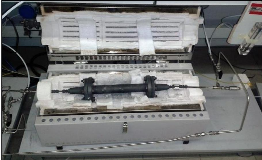
**Figura 3.7:** Montaggio del canning nel reattore
