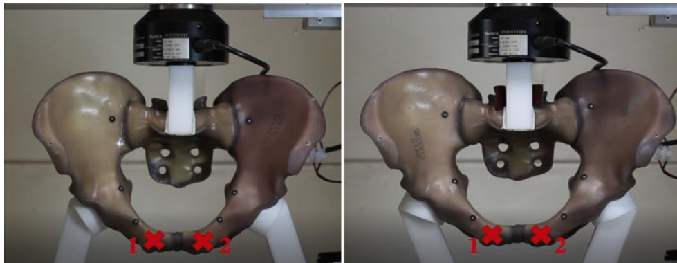
Figura 2.13: (a) Prova su campione pelvico con sinfisi intatta (Configurazione 1); (b) Prova su campione pelvico con sinfisi intatta (Configurazione 2);
