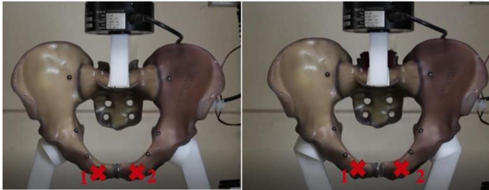
Figura 2.15: (a) Prova su campione pelvico con sinfisi fratturata (Configurazione 2); (b) Prova su campione pelvico con sinfisi fratturata (Configurazione 1);
