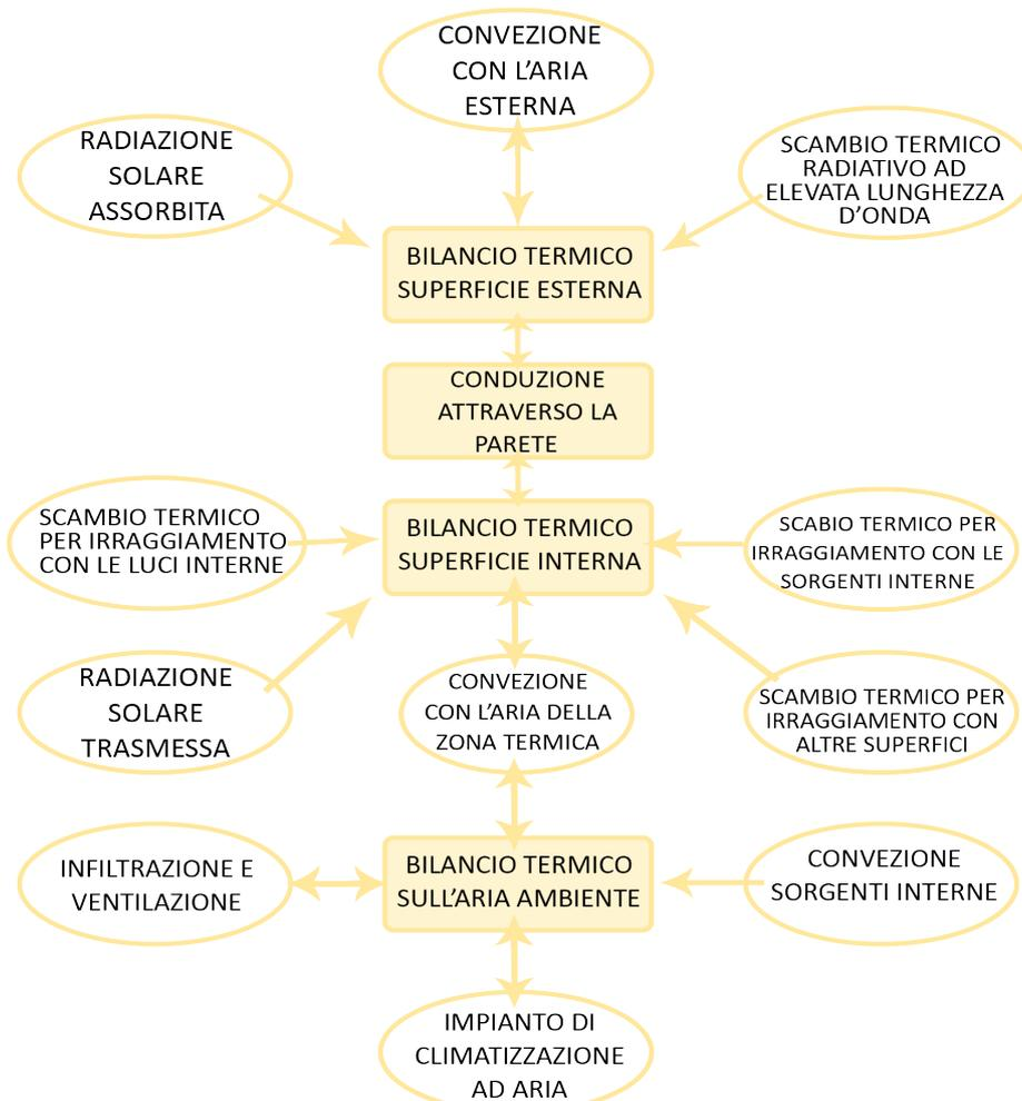
[Figura 4]: Schema delle componenti che influiscono sui bilanci termici delle superfici e dell'aria [37]
