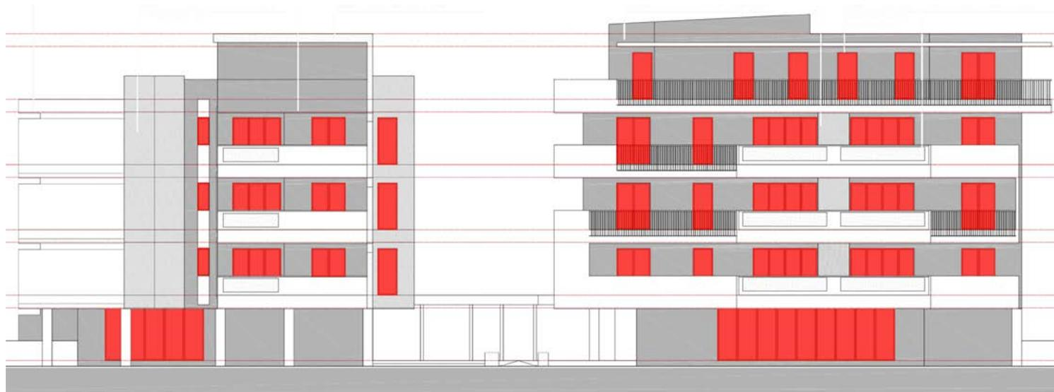
Sono stati analizzati anche gli infissi esterni verticali dell'edificio, i quali coprono una superficie considerevole di circa 490 m<sup>2</sup> sull'involucro esterno.
