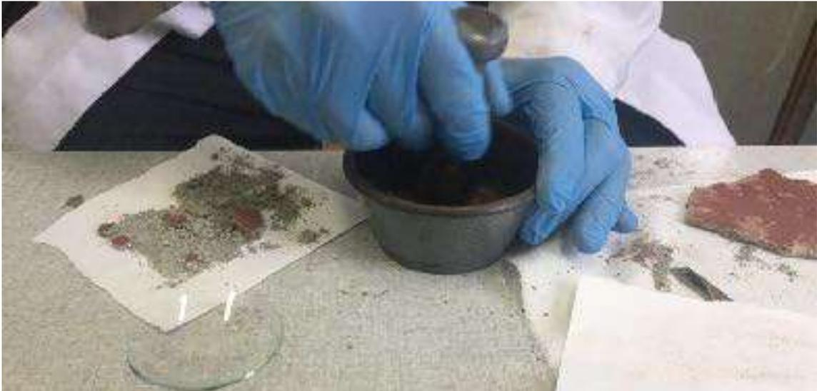
Fig.63 Macinazione dell'intonaco con l'utilizzo di un piccolo mortaio da laboratorio.
