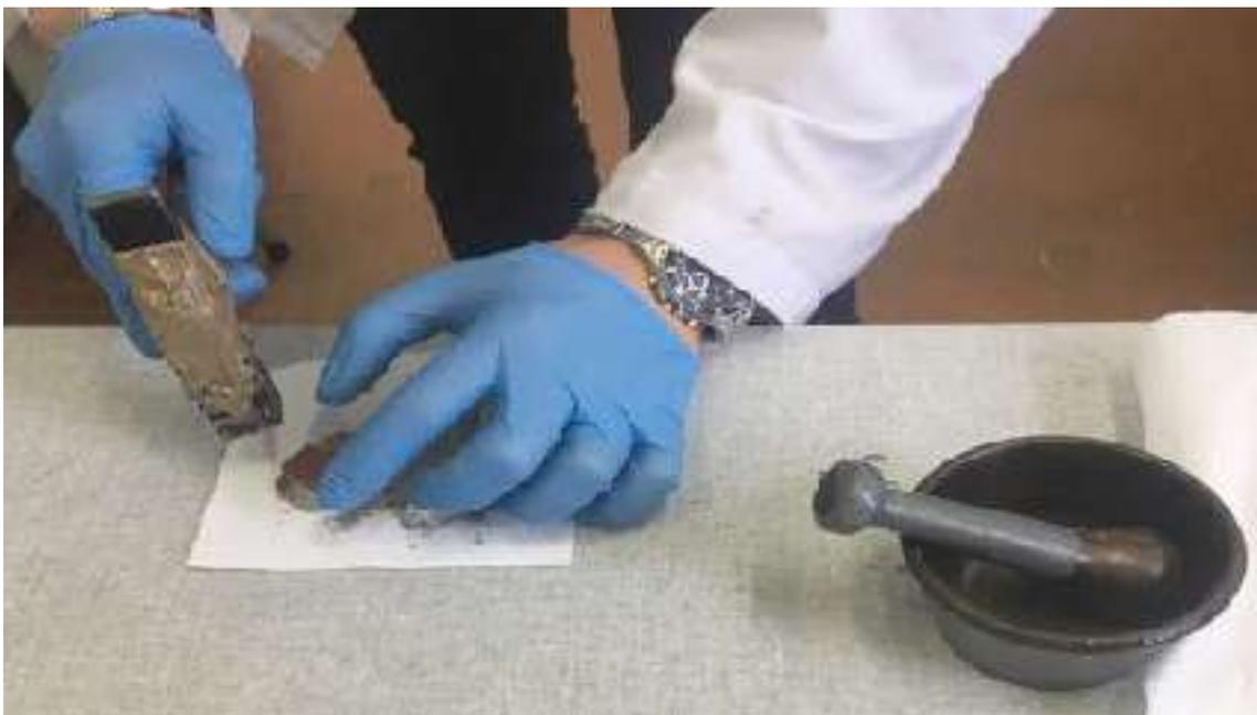
Fig.62 *Fase di frantumazione dell'intonaco*
