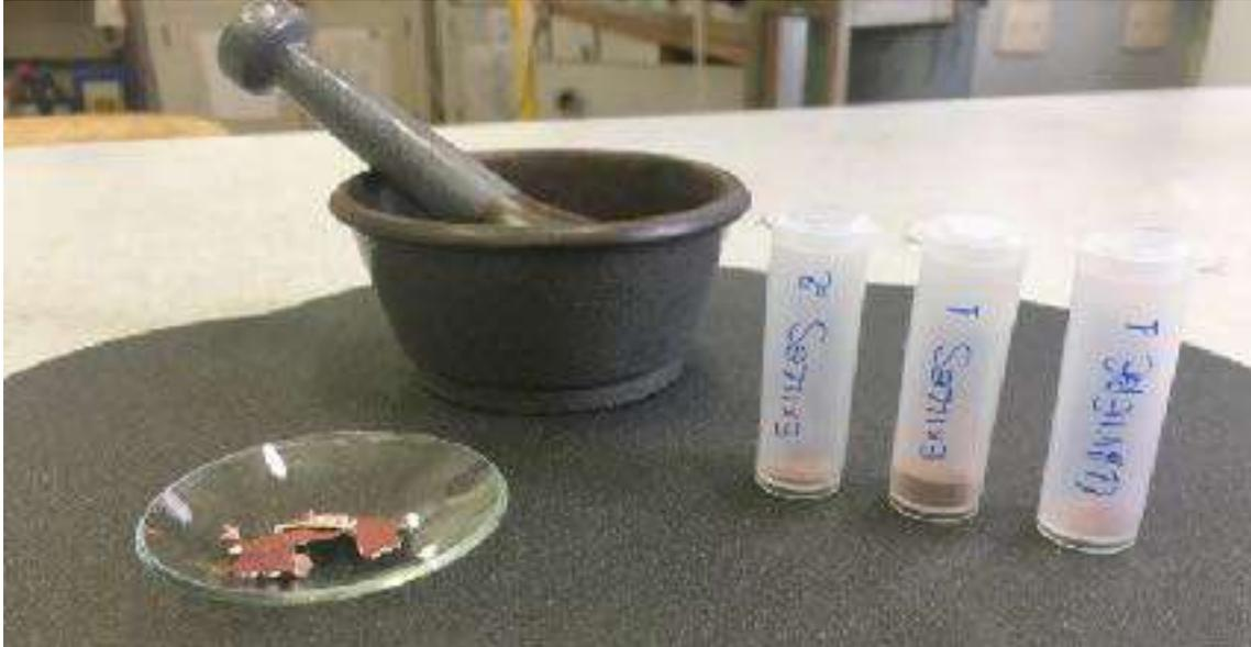
Fig.61 *Mortaio e pestello utilizzati per ottenere la polvere di intonaco, classificata nei tre diversi provini.*
