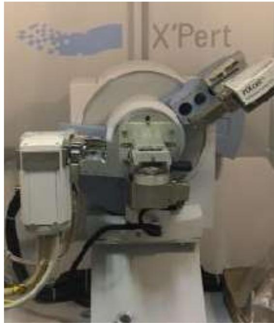
Fig.66 Dettaglio del macchinario PANalytical X'Pert PRO in funzione.
