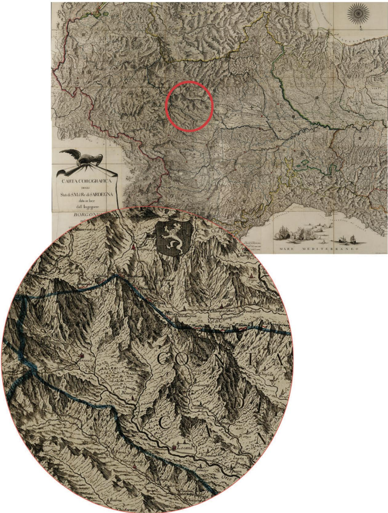
Nello stralcio della carta si osserva che in essa è assente il disegno dei rilievi, utile per la localizzazione corretta delle località ottenuta con l'uso della triangolazione.
