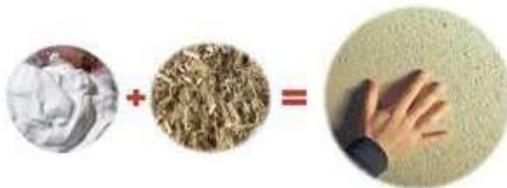
Fig. 2.18 Elementi che compongono il conglomerato canapa e calce
