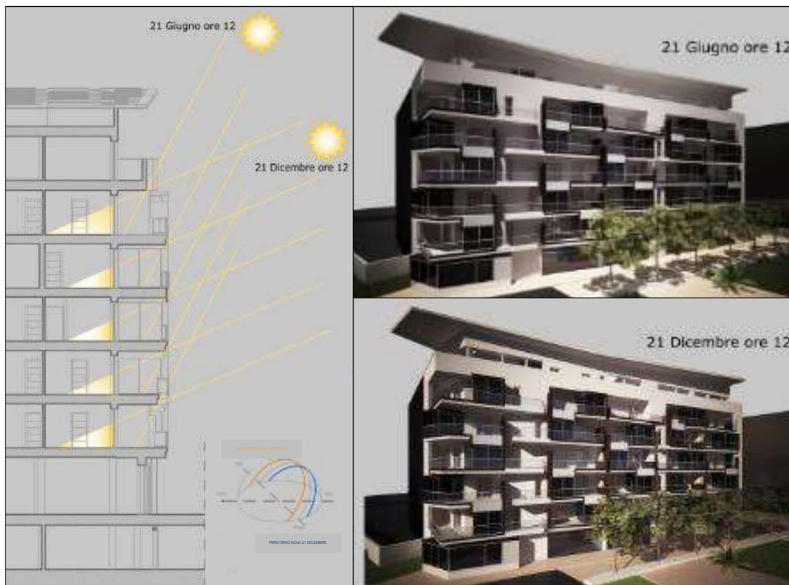
Fig. 6.89 Serre bioclimatiche: captazione solare in inverno e schermatura in estate
