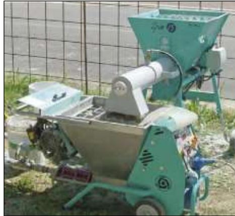
Fig. 2.23 Miscelatore a vite senza fine da cantiere.
