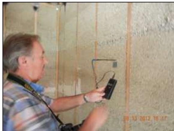
Fig. 5.59 Misurazione dell'umidità con opportuni apparecchi
