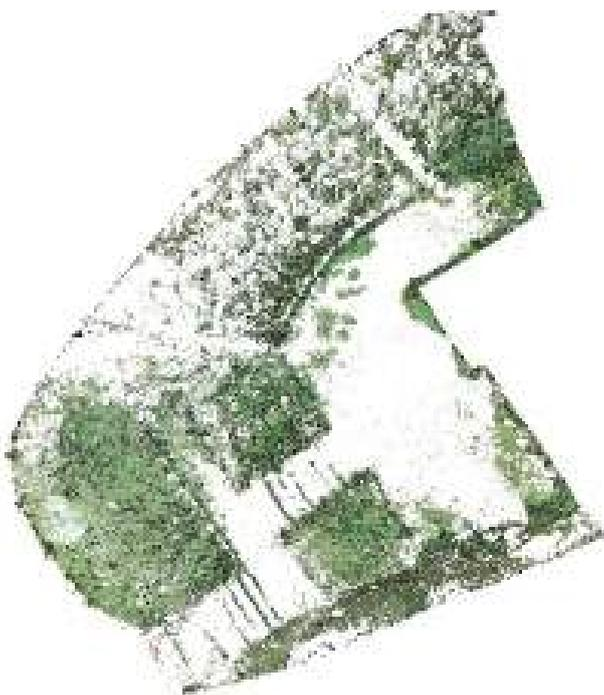
Porzione di nuvola rimossa a seguito del campionamento delle tonalità di colore verde.
