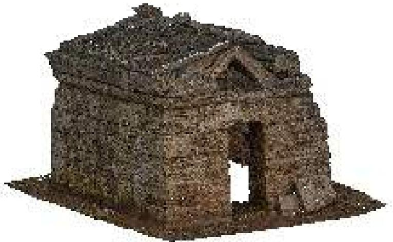
Nuvola di punti ottenuta tramite la fotogrammetria terrestre.
