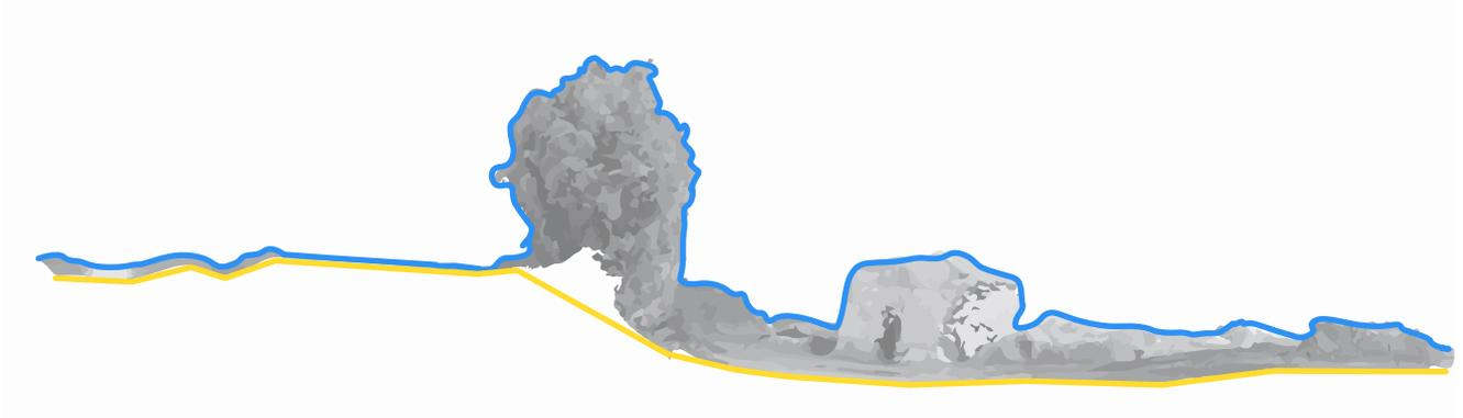
Necropoli di San Cerbone, ritaglio nuvola di punti in prossimità della Tomba del Bronzetto dell'Offerente. Schematizzazione delle due superfici statistiche: DEM e DTM.
