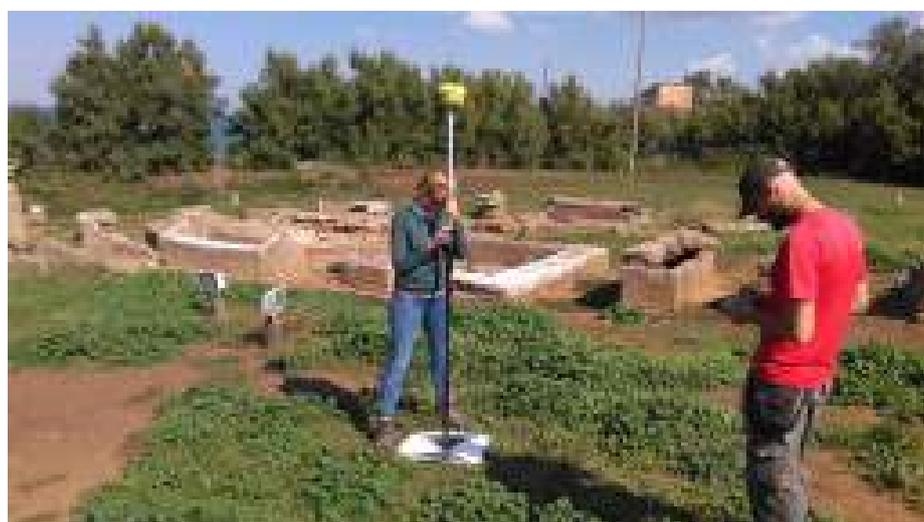
Misurazione dei marker tramite il sistema RTK, Necropoli di San Cerbone.
