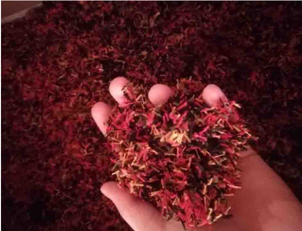
fig. 1 – Scarti industriali tessili sminuzzati di dimensioni comprese tra 2 e 7mm.
