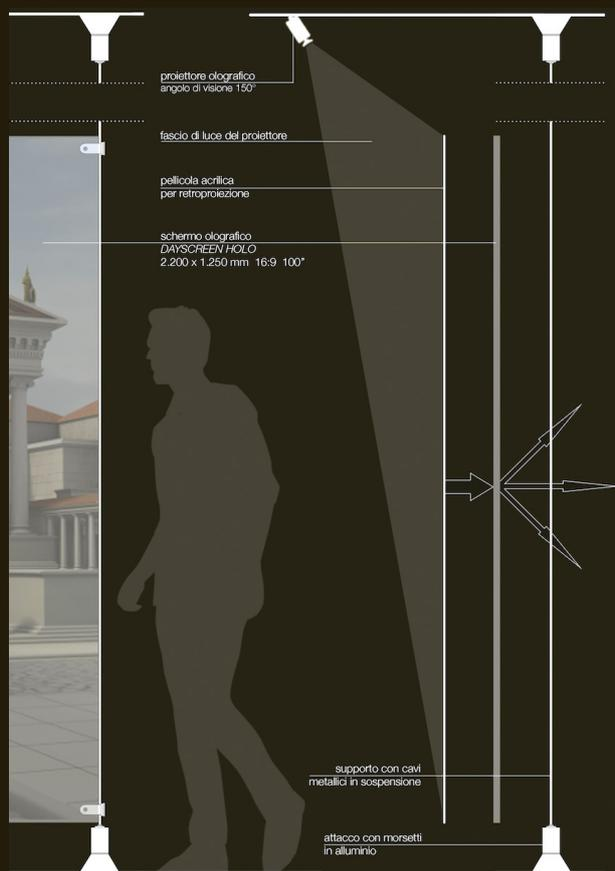
**fig.75** Ce.M.A.C.: il progetto degli espositori. Le proiezioni olografiche. Elaborazione dell'Autore.
