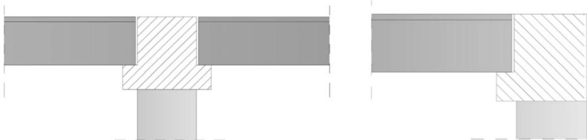
Figura 20 \_ disposizione ed utilizzo delle travi rovesce a T e a L
