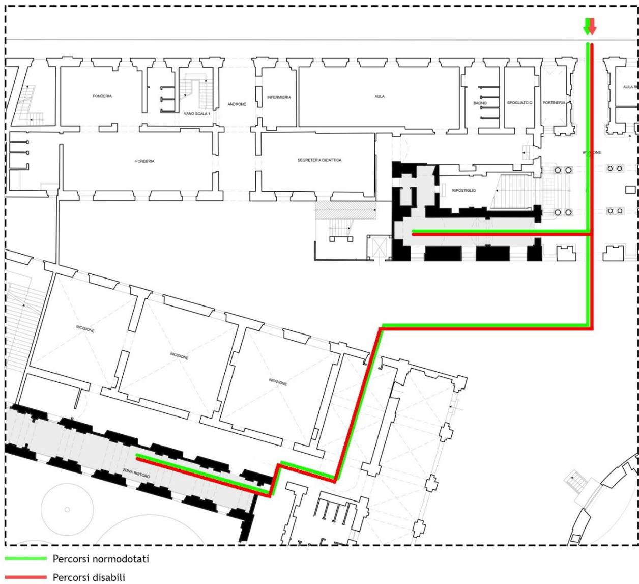
Figura 67. Schema "accessibilità percorsi" spazio studenti, piano terra.
