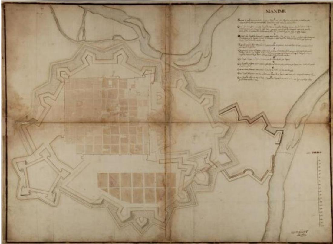
Fig.22 - Progetto di ingrandimento delle fortificazioni di Torino verso il Po. Torino, progetto di ingrandimento delle fortificazioni verso il Po. 1632. Firmato Montafilans. Carta su tela. Inchiostro marrone, acquerello verde, marrone, grigio. Scala di Trabucchi 200 = cm. 20,3. Archivio di Stato, Corte, Carte topografiche per A e B, cartella Torino 4. Fonte: <http://archiviodistatorino.beniculturali.it>.
