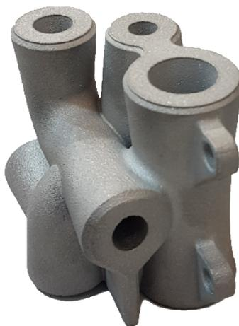
Figura 2.3: Pezzo in acciaio realizzato con *additive manufacturing* da Renishaw mediante applicazione di vari strati di polvere di metallo fusi grazie al laser. Il pezzo presenta una resistenza meccanica superiore rispetto al corrispondente componente prodotto mediante fusione ed estrusione.
