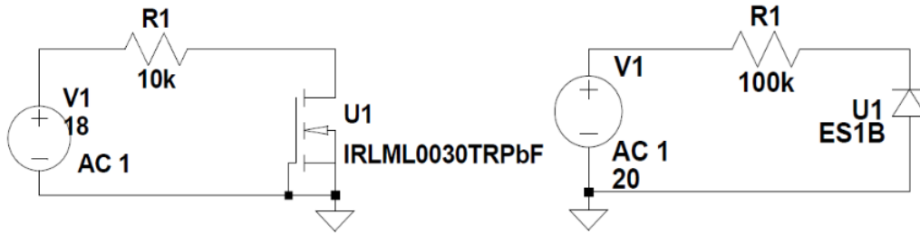
Figura 4.2.0.2: LPF con MOS e diodo.
