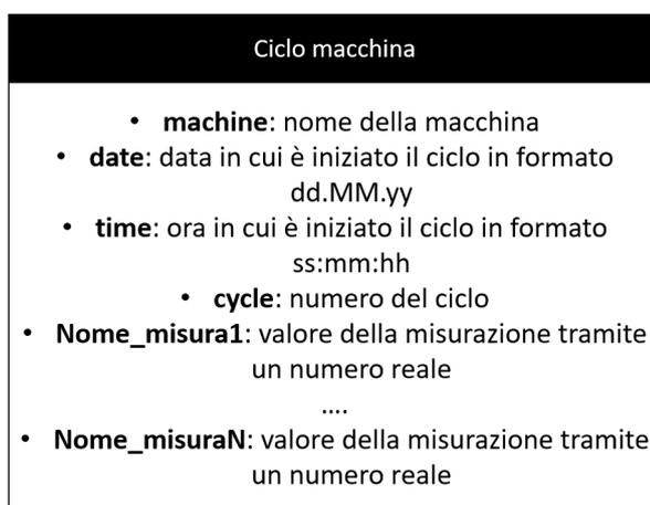
Figura 4.7. Struttura del database *nome\_macchina\_db*
