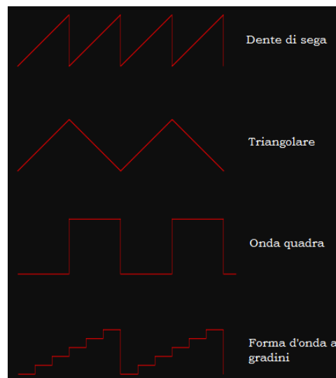
Figura 9 Pattern di modulazione comuni per un Radar FMCW
