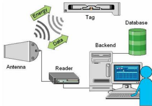
Fig. 1.4: Schema base di un sistema RFID. Fonte: Una introduzione alla tecnologia RFID , Roberto Marani Anna, Gina Perri, Dipartimento di Ingegneria Elettrica e dell'Informazione, Laboratorio di Dispositivi Elettronici, Politecnico di Bari
