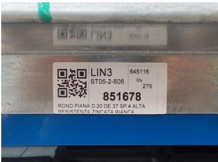
Figura 81. Etichetta applicata sulla traversa di uno scaffale per l'identificazione della posizione
