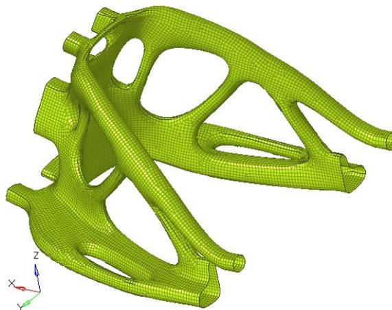
Figura 3.105 Mesh di tipo *Shell* a quattro nodi su corpo centrale
