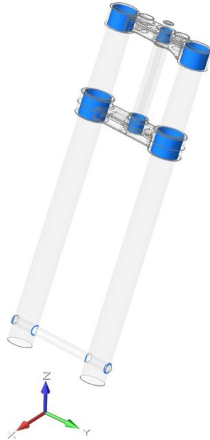
Figura 3.6 Contatti saldati su avantreno
