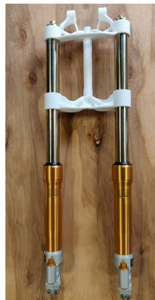
Figura 4.1 Prototipi piastre ed asse canotto sterzo
