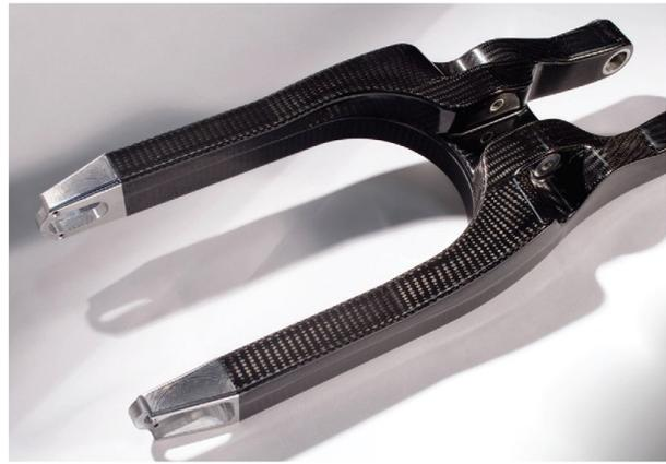
*Figura 1.17 Forcellone di una Honda CRF450, riprogettato in fibra di carbonio [18]*
