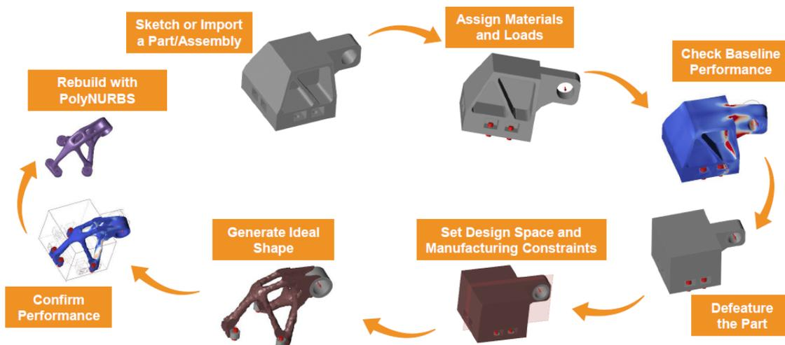
Figura 1.11 Step necessari per l'ottimizzazione topologica [14]
