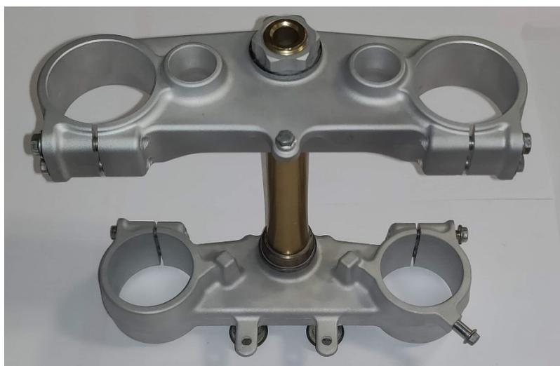
Figura 2.45 Piastre sterzo, superiore e inferiore, e asse canotto sterzo Suzuki RM 125
