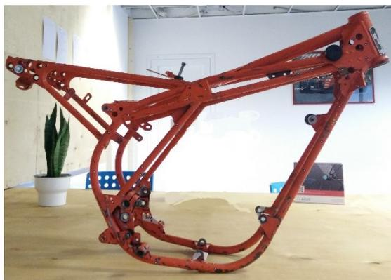
Figura 2.5 Telaio originale culla motore
