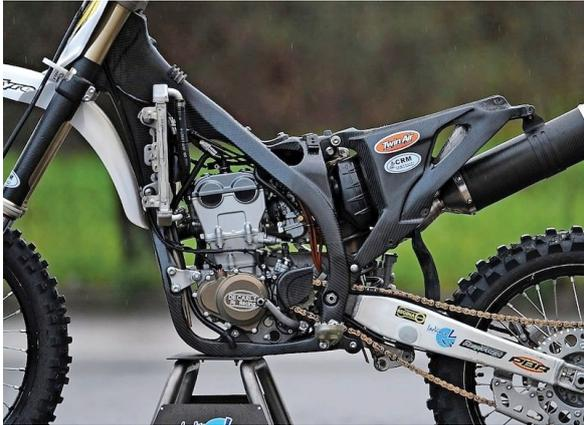
*Figura 1.16 Telaio motocross prodotto da CRM Compositi S.R.L.U. [17]*
