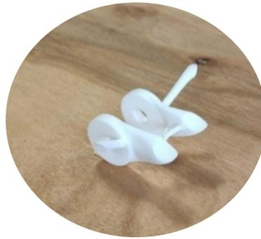
Figura 4.4 Prototipo supporto ammortizzatore progettato tramite processo di ottimizzazione topologica
