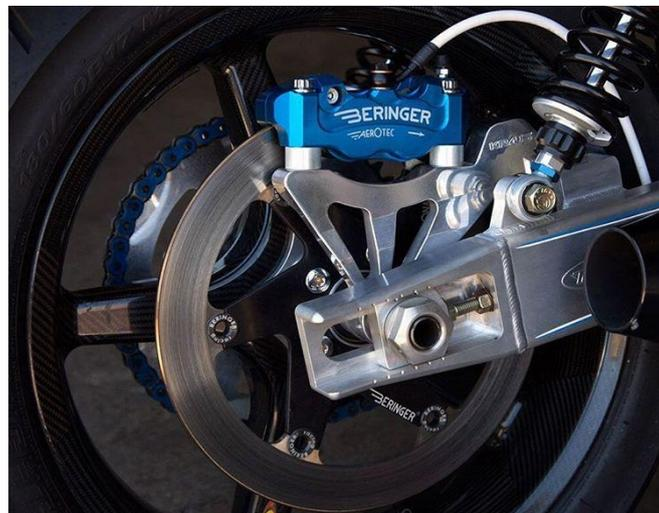
Figura 2.37 Montaggio radiale pinza freno posteriore [28]
