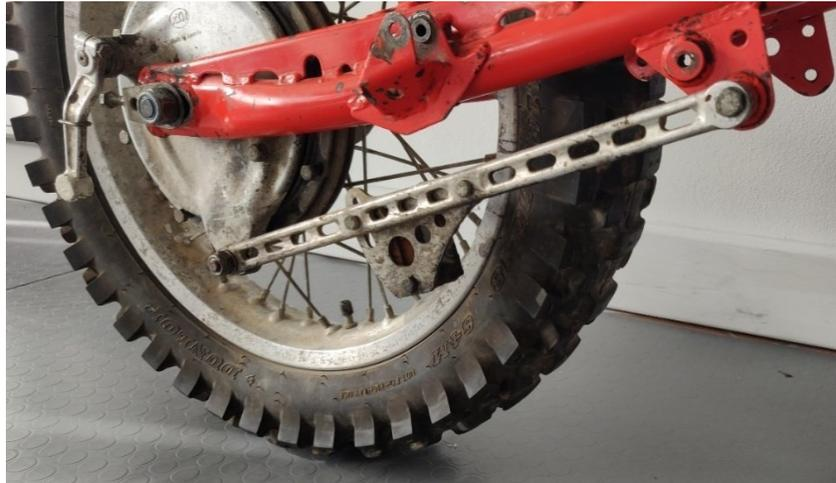
Figura 3.74 Sistema di bloccaggio freno a tamburo
