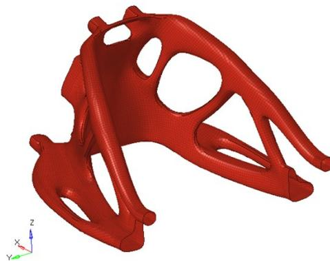
Figura 3.114 Mesh di tipo shell sul componente in fibra di carbonio
