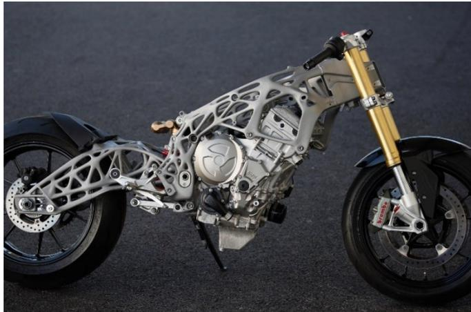
Figura 1.19 Moto in Additive Manufacturing di produzione BMW [20]
