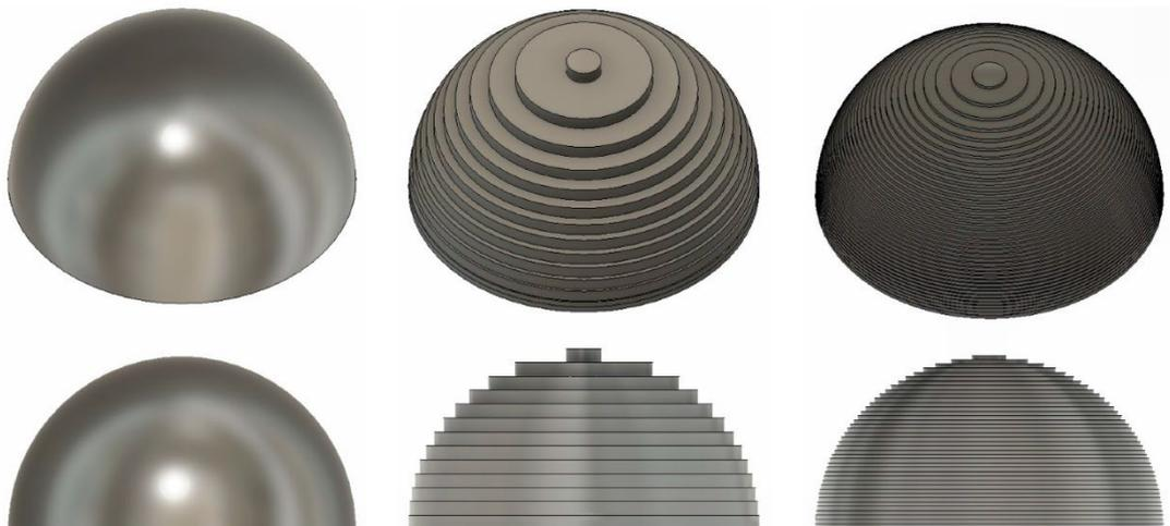
Figura 2.16 Effetto staircase in funzione del  $\Delta s$ .
