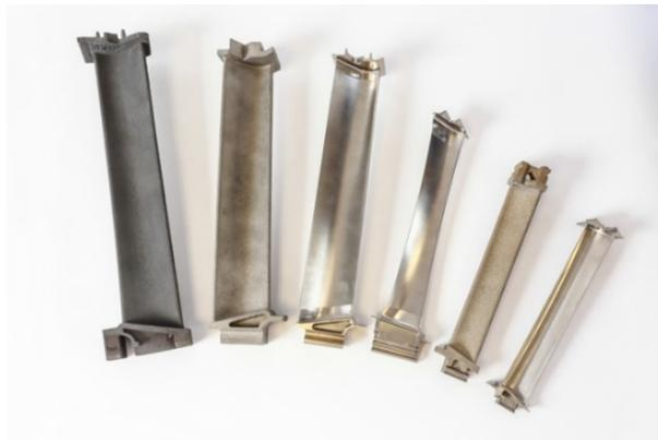
Figura 2.2 Palette della turbina di bassa pressione del motore aeronautico GE9X, realizzate in EBM presso lo stabilimento di Cameri (NO) da Avio Aero [6].
