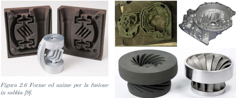
Figura 2.6 Forme ed anime per la fusione in sabbia [9].
