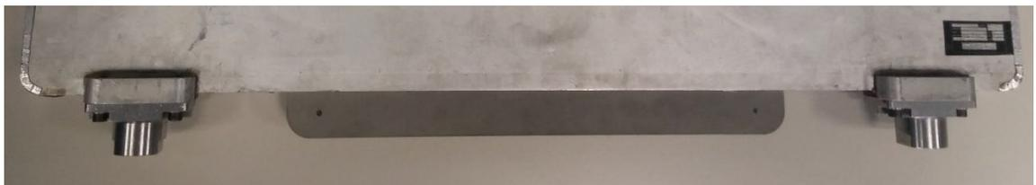
Figura 5.8 Supporti del Pannello Multifunzione (full-scale).
