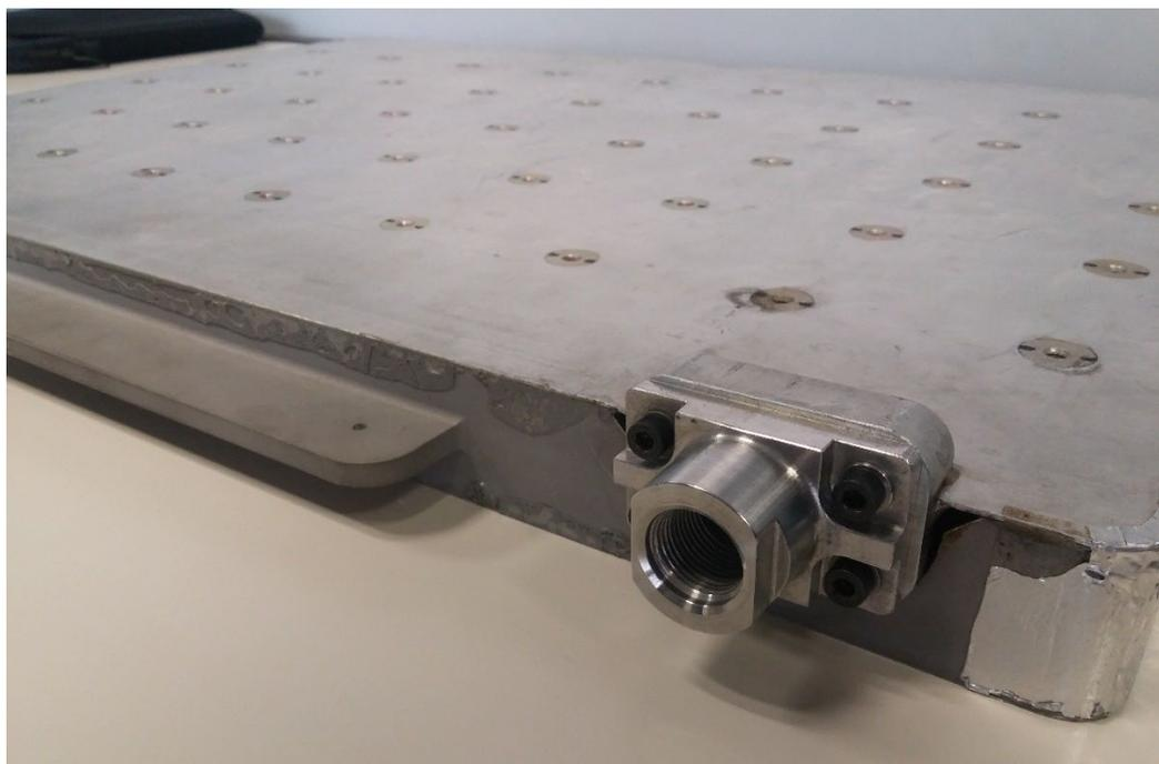
*Figura 5.6 Particolare del terminale fluidico.*
