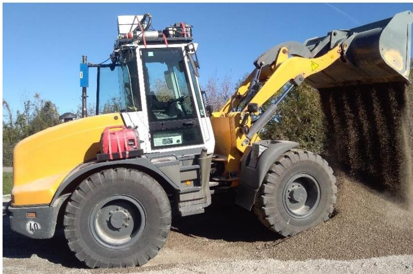
*Figura 5.1 Veicolo usato per i test RDE dotato di strumentazione PEMS (sopra la cabina)*
