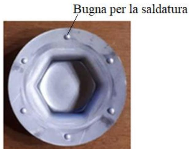
**Figura 83:** 6 bugne per facilitare la saldatura del componente sulla coppa
