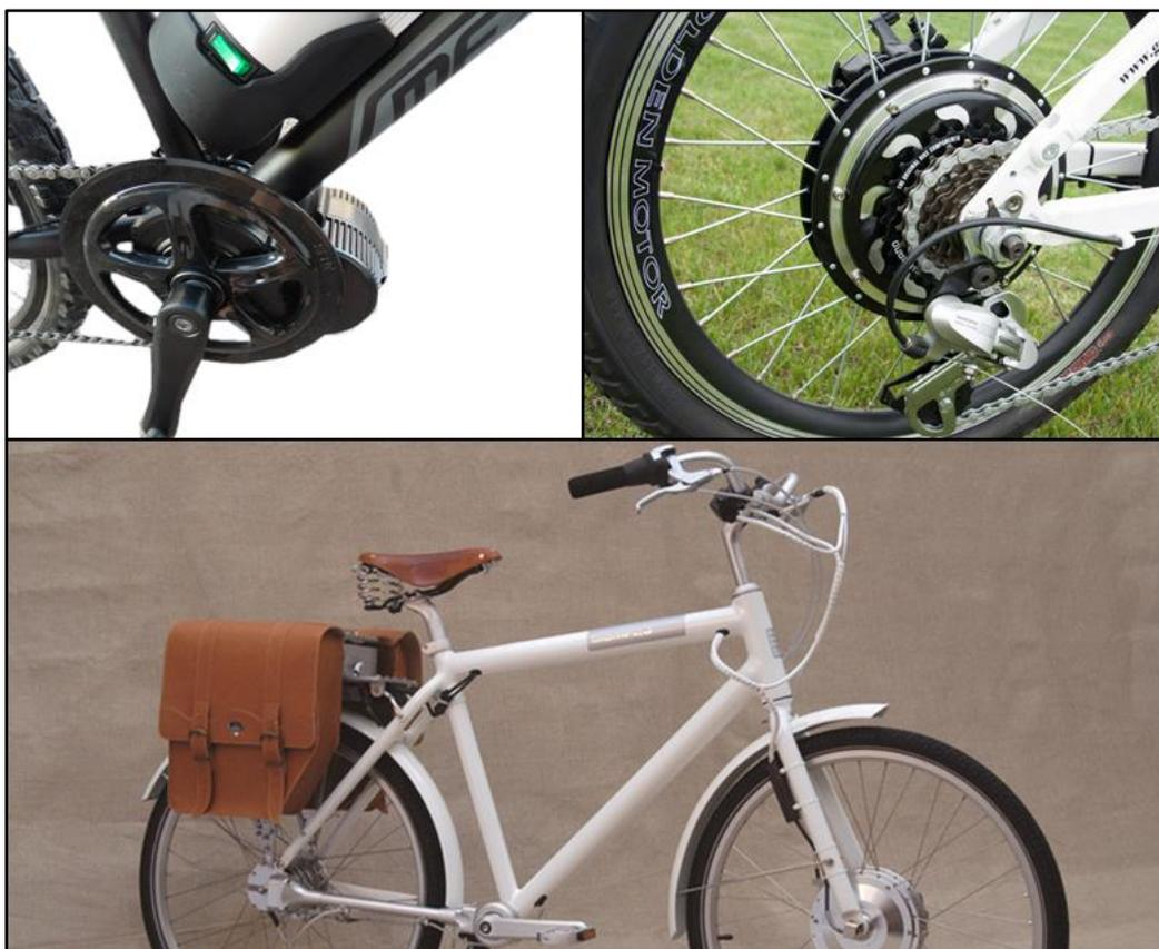
Figura 12 - Diverse configurazioni della collocazione del motore: sopra, al mozzo centrale e posteriore; sotto, al mozzo anteriore
