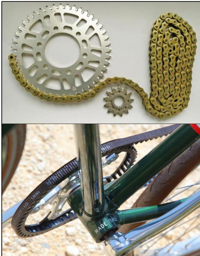
**Figura 56 - Sistemi di trasmissione usati nel settore della propulsione umana: trasmissione a catena, sopra, e a cinghia dentata, sotto**
