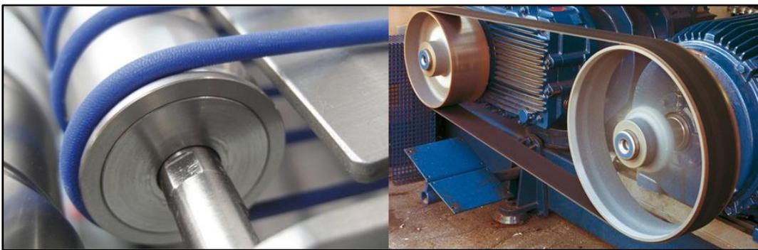
Figura 59 - Esempi di trasmissione a cinghia tonda e piatta
