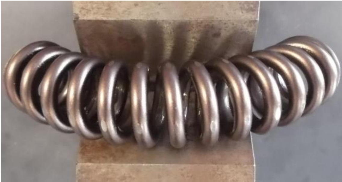
Figura 3.3 Usura in corrispondenza delle spire della molla ad arco [5]
