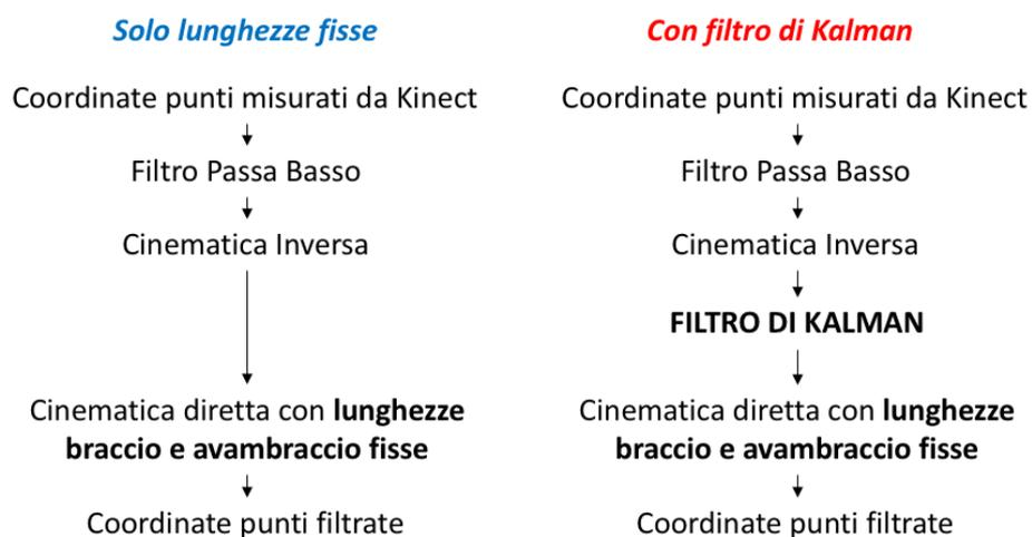
Figura 4.33 Schema sul confronto eseguito fra effetto della sola imposizione delle lunghezze fisse e dell'effetto del filtro di Kalman con imposizione delle lunghezze fisse
