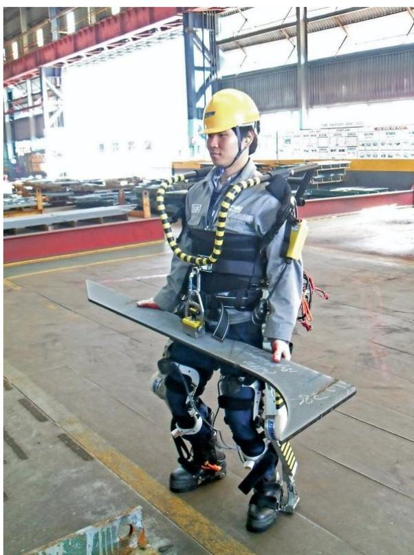
**Figura 11** – Prototipo di esoscheletro per cantieri navali in azione tratto da (35)
