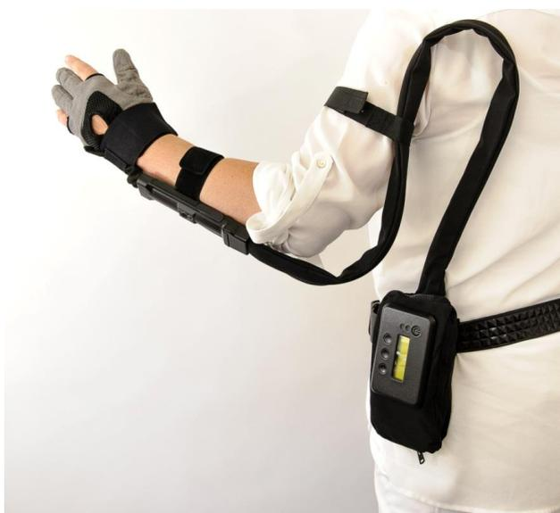
**Figura 10** – Intero sistema che compone il SEM GLOVE tratto da (34)
