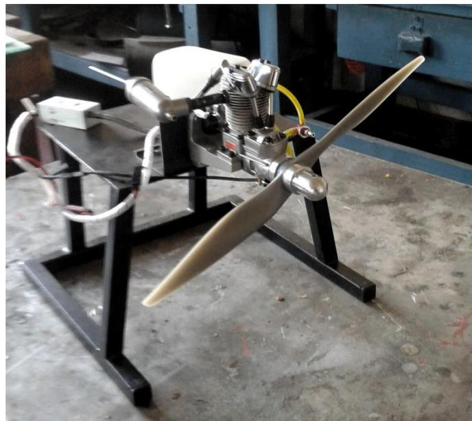
*Figura 4.2 - Banco prova motore*
