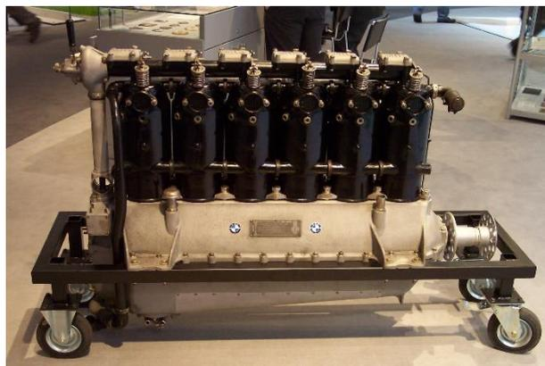
Figura 3.8 - BMW IVa 6 cilindri in linea (5)
