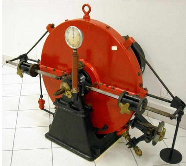
Figura 2.2 - Freno dinamometrico Ranzi, Museo Storico dei Motori e dei Meccanismi, UniPa (2)
