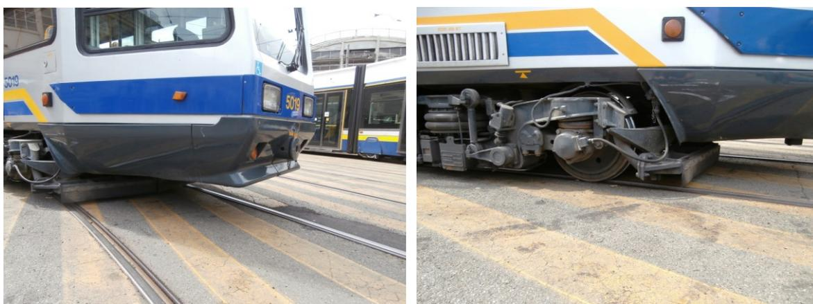
Figura 18 – Cityway Alstom-Fiat Ferroviaria: esempio di carrello privo di coperture laterali
