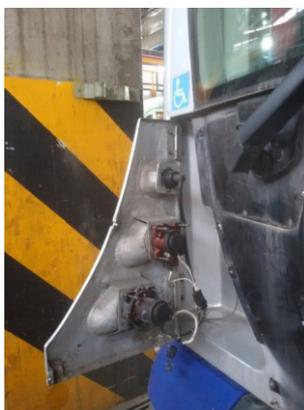
Figura 18 – Pannello fari del tram Cityway Alstom a Torino in posizione aperta per manutenzione
