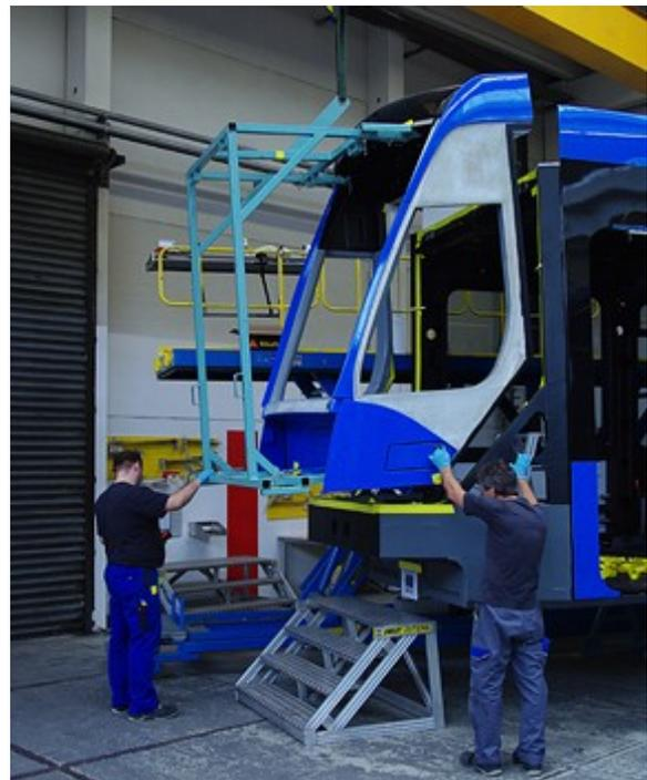
Figura 14 – Esempi di maschere di tram
