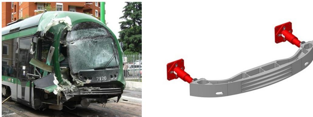
Figura 11 - Ciò che resta del frontale di un tram Sirio Milano a seguito di un incidente. In primo piano è visibile, praticamente indeformata, la trave che connette i respingenti
