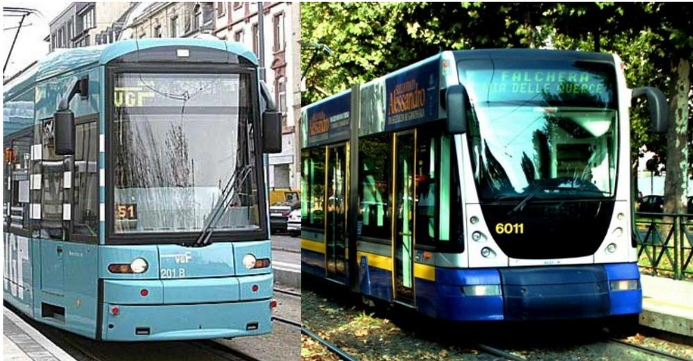
Figura 15 – Esempio di “paraurti” del tram realizzato con pannelli in poliuretano
