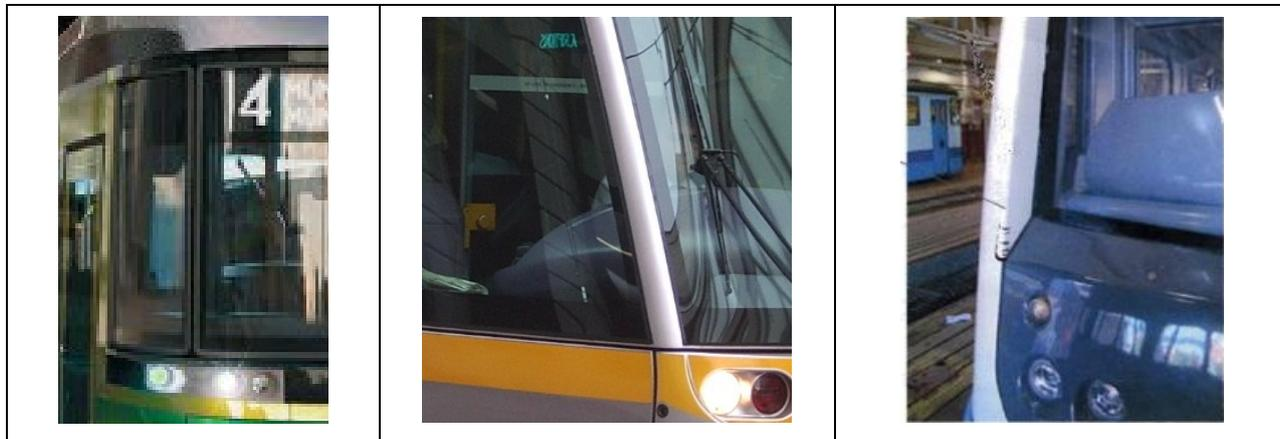
**Figura 29 – Differenti soluzioni costruttive per il montante**
