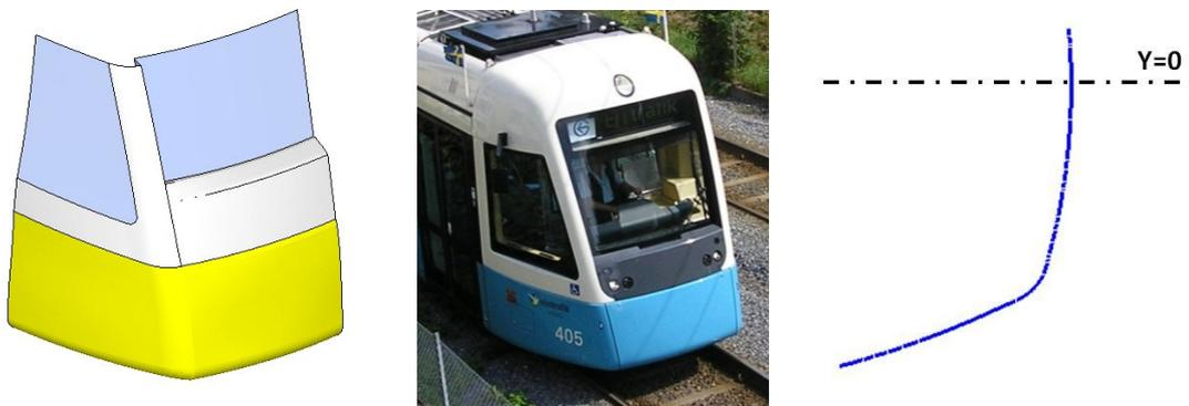
Figura 56– Modello ad elementi “facet” del frontale utilizzato per gli urti “offsettati”
