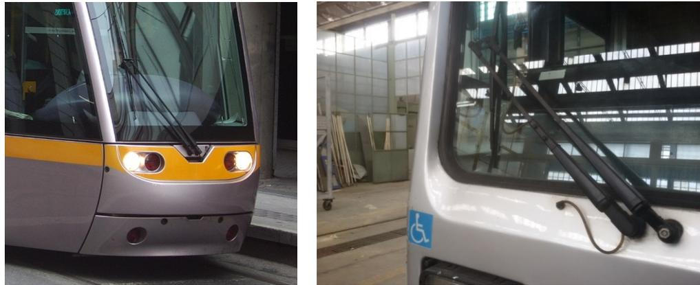
Figura 19 – Esempi di soluzione per il tergicristallo: in entrambi i casi il perno alla base del braccio non è coperto.
