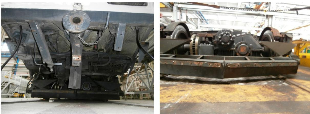
**Figura 17 – Sotto-cabina del tram Cityway Alstom-Fiat Ferroviaria di Torino: sono chiaramente visibili l’accoppiatore e il rostro per la protezione del carrello**
