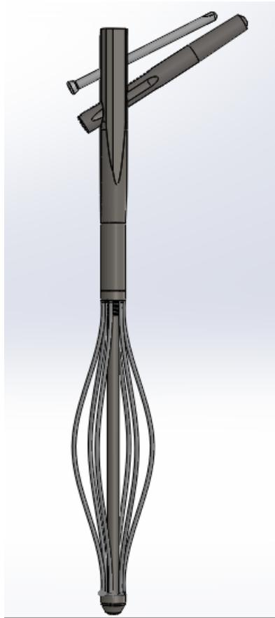
Figura 1.18: Rappresentazione del chiodo innovativo con meccanismo di bloccaggio distale espandibile
