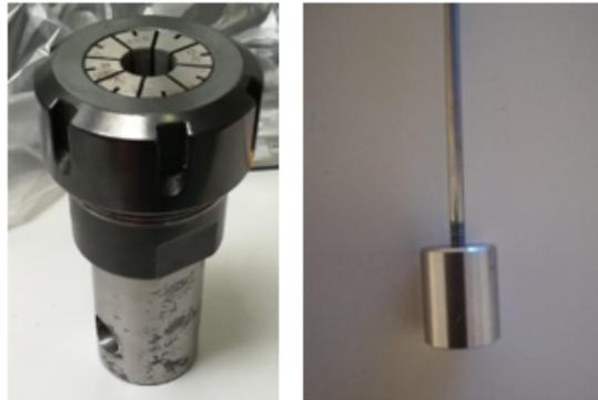
Figura 2.5: Afferraggio a mandrino (sinistra), utilizzo di un cilindro metallico filettato per interfacciare il filo all'afferraggio disponibile (destra)
