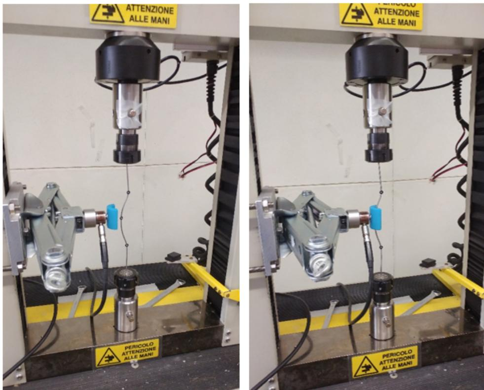
Figura 2.6: Apparato sperimentale: variazione della posizione orizzontale della cella con l'utilizzo del cric
