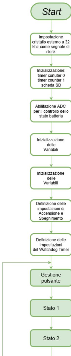
Figura 2.10 diagramma di flusso: firmware inizializzazione
