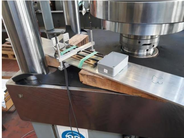
Figura 139: Nodo multi - sensore di deformazione
