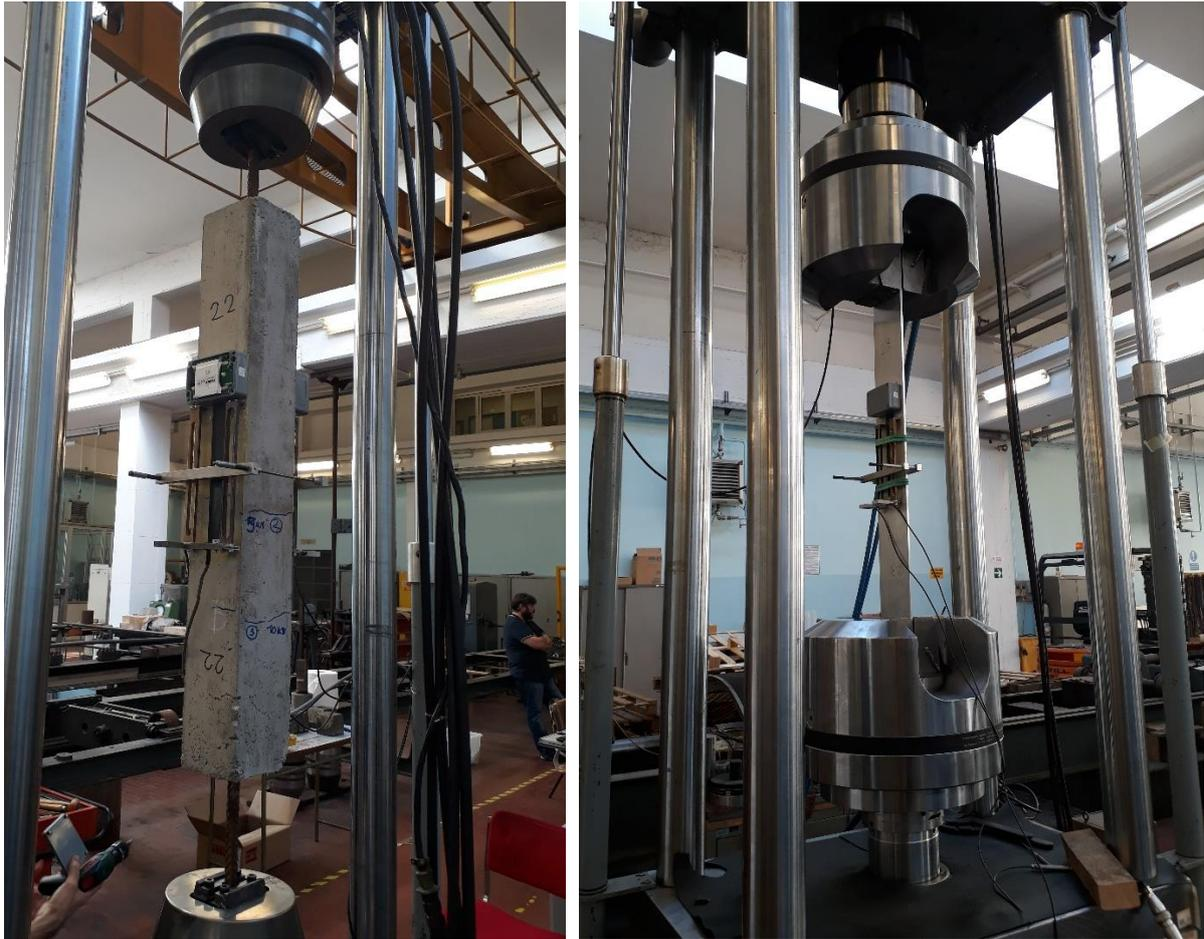
Figura 141: Tirante in cemento armato(sx) e lastra di alluminio(dx) testati presso il laboratorio del DISEG del Politecnico di Torino
