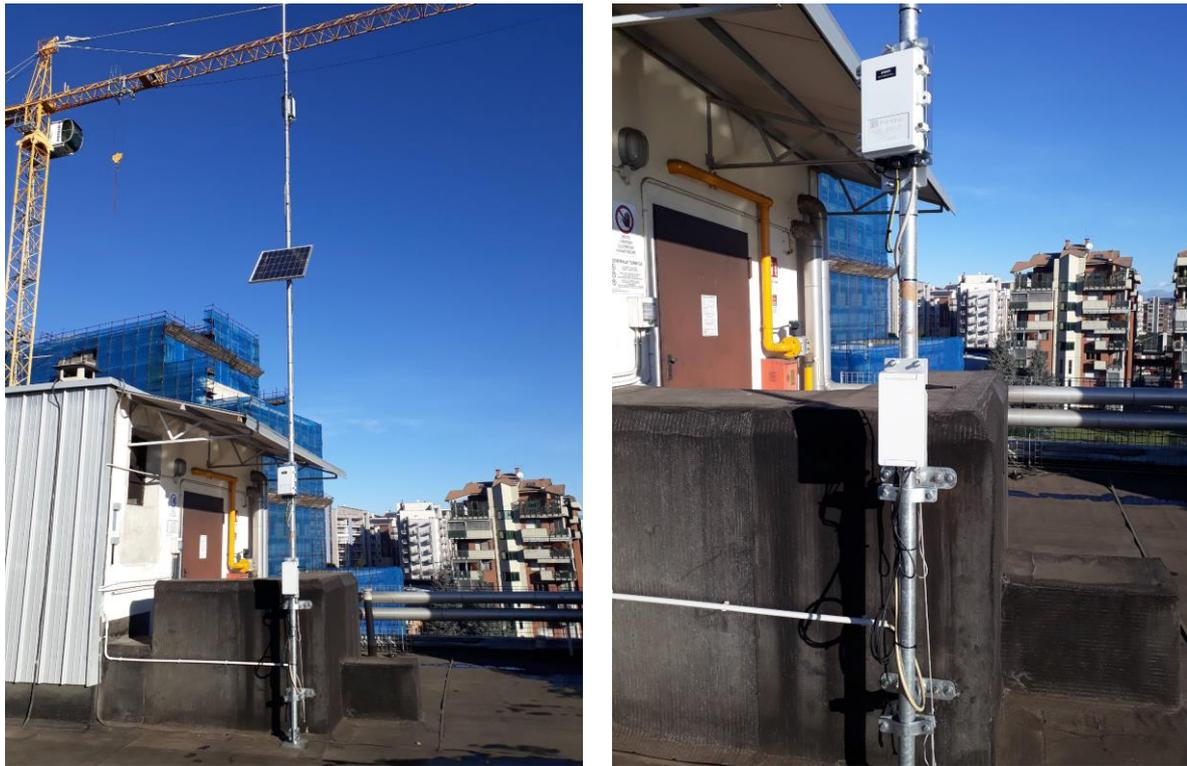
*Figura 140: Vista del gateway equipaggiato con pannello solare (sx) e dettaglio del dispositivo (dx)*
