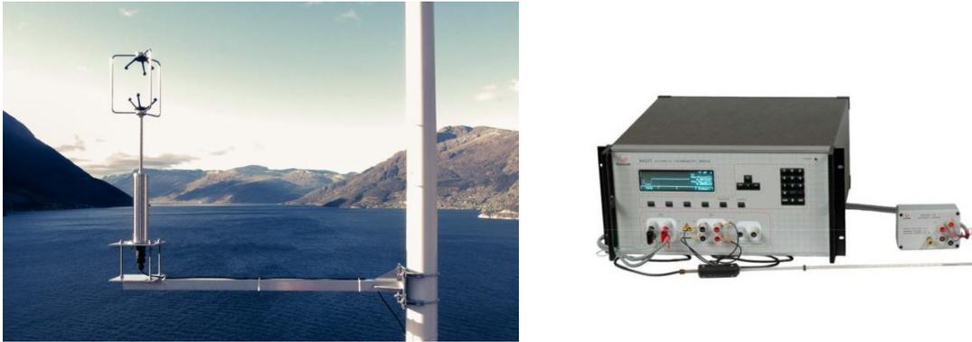
Figura 4: Anemometro (sx, da NTNU/Knut Andreas Kvåle) e Termometro (dx, da Evolution Measurement)
