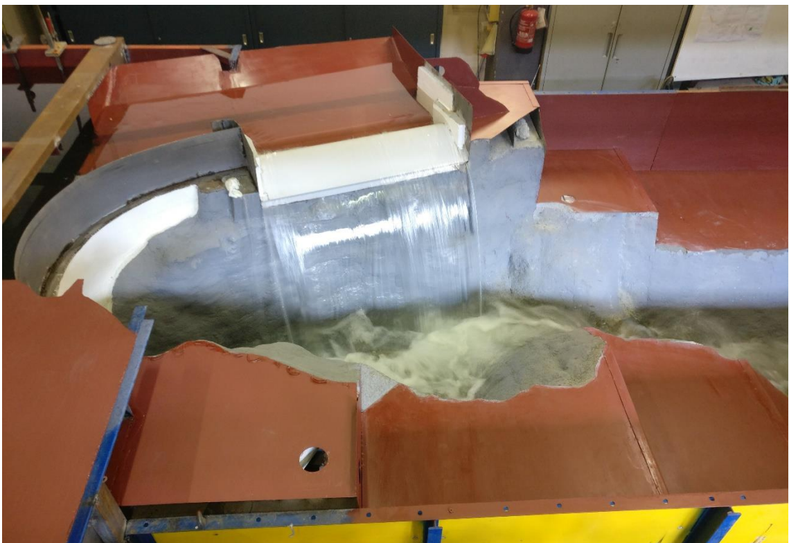
Figura 16: funzionamento sfioratore laterale
