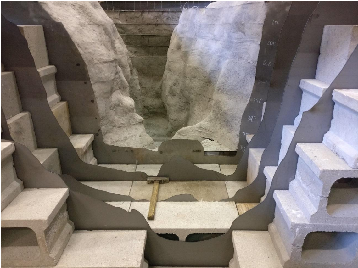
Figura 13: posa delle lamiere del secondo tratto di valle
