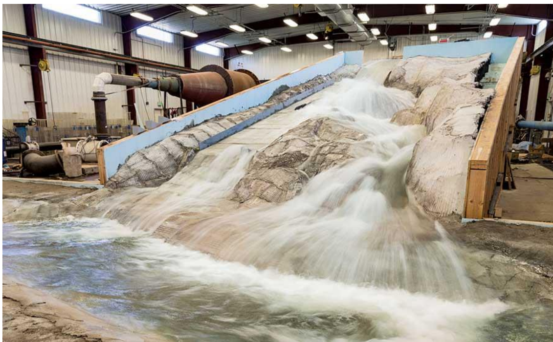
Figura 8: modello fisico Oroville Dam
