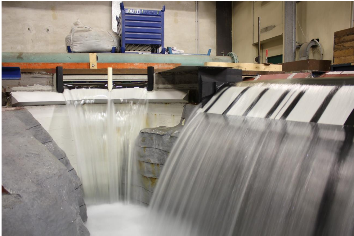
Figura 18: funzionamento degli sfioratori
