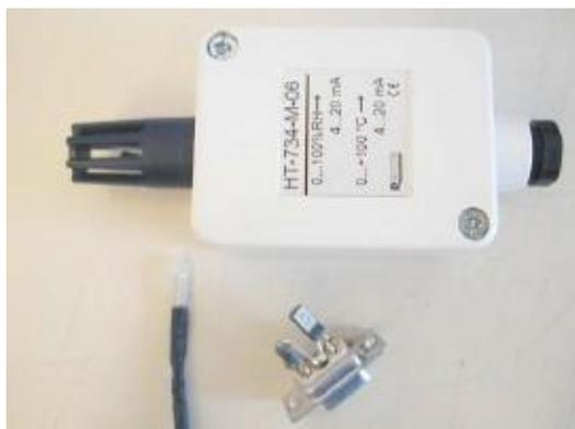
**Figura 3.9:** Sensore d'umidità
