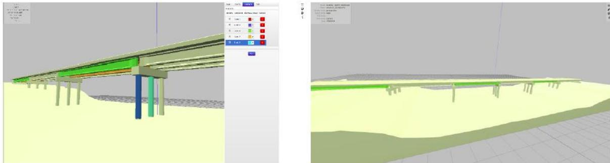
**Figura 5.8:** Esempio di visualizzazione CAD 3D per gli elementi monitorati
