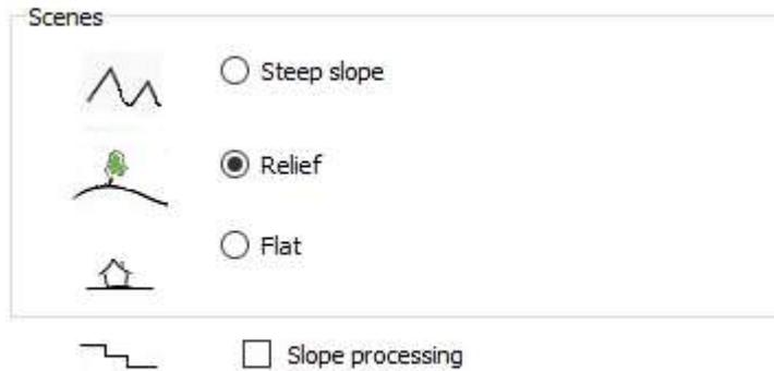
**Figura 4.6** Possibili conformazioni del terreno: primo caso terreni particolarmente ripidi; secondo caso terreni con una lieve pendenza e terzo caso terreni piani. La possibilità di scegliere lo *slope processing* permette al programma di generare una maglia che segue terreni che hanno puntuali e bruschi cambi di pendenza.
