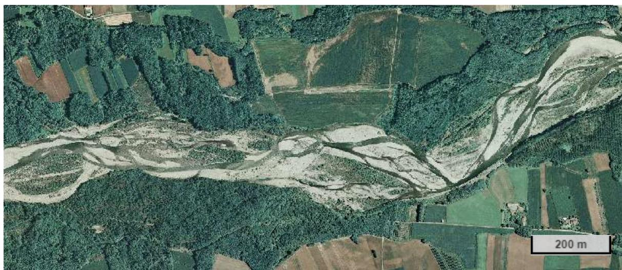
**Figura 2.3** Torrente a canali intrecciati. Il torrente Pellice tra Vigone e Villafranca.
