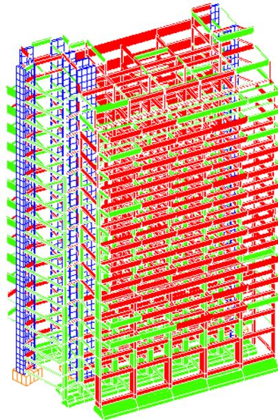
Figura 81 Colormap verifiche elementi a pressoflessione, Edificio B
