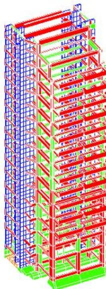
Figura 98 Colormap verifiche elementi a pressoflessione, Edificio C appartenente al Modello globale
