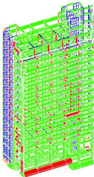
Figura 116 Colormap verifiche elementi a taglio, Edificio D appartenente al Modello globale
