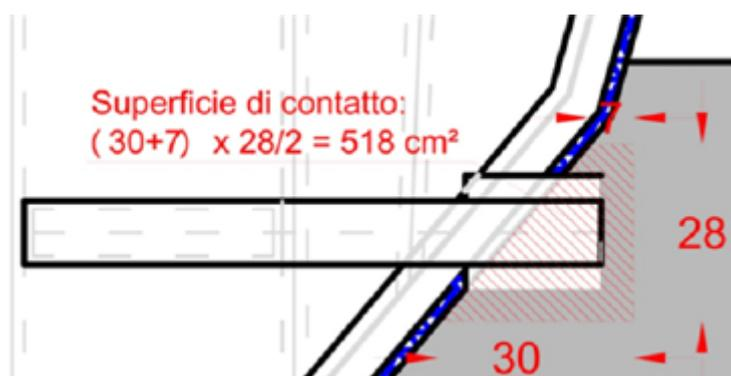
**Figura 10:** Ricostruzione della superficie di appoggio nella condizione prevista da CSA con la presenza dei sacchetti di sabbia per una migliore ripartizione del carico
