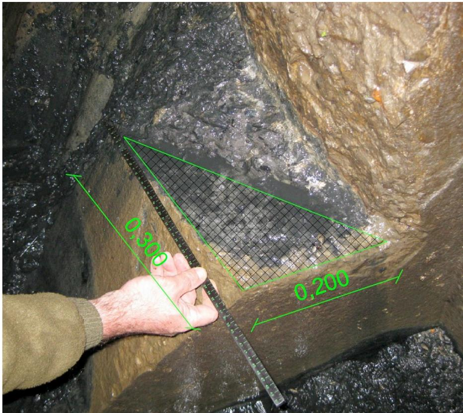
**Figura 87:** Geometria della superficie di frattura di riferimento  $A_F$
