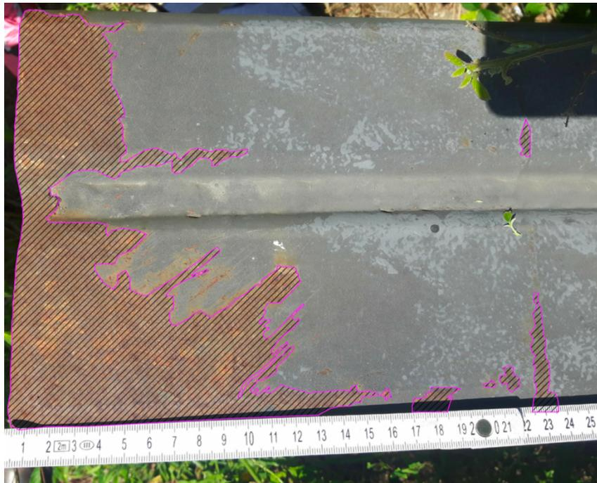
*Figura 70: Particolare della superficie di contatto caratterizzata dalla presenza di abrasione (da fascicolo fotografico dell'ultimo sopralluogo)*
