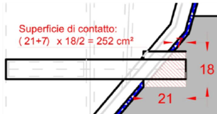
**Figura 9:** Ricostruzione della superficie di appoggio nella condizione reale di carico, senza la presenza dei sacchetti di sabbia
