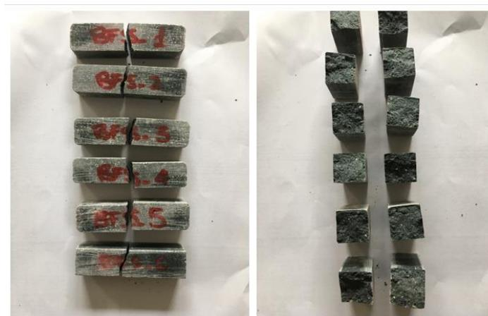
Figura 4-12: Provini della stessa malta, rotti a flessione generando due monconi
