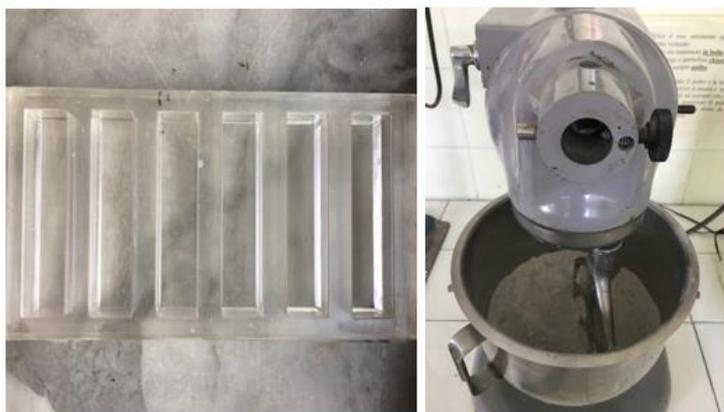
Figura 4-6: A sinistra stampi per provini prismatici di 80x20x20 mm, a destra mescolatrice costituita da planetaria e da paletta in acciaio inossidabile
