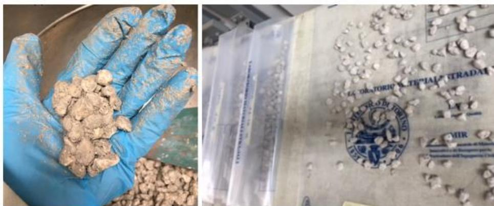
Figura 4-22: Prova del guanto e Stagionatura in ambiente asciutto
