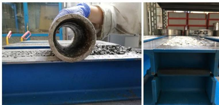
Figura 4-21: Costipamento strato superficiale e visualizzazione superfice piana
