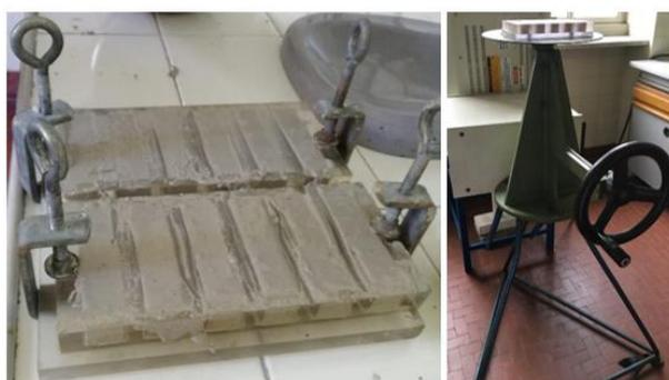
Figura 4-7: A sinistra provini finiti, a destra apparecchiatura a scosse per la compattazione dei provini in malta
