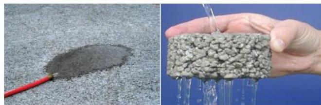
Figura 1-4: Conglomerato cementizio poroso permeabile all'acqua. A sinistra è possibile notare il fenomeno dell'infiltrazione con mancato ruscellamento superficiale su una pavimentazione stradale, a destra si evidenzia il passaggio dell'acqua attraverso un campione in conglomerato poroso.
