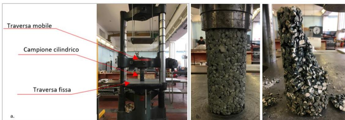
Figura 4-25: a. apparecchiatura Zwick Roell, b. corretta posizione di prova del provino e c. campione cilindrico rotto a compressione
