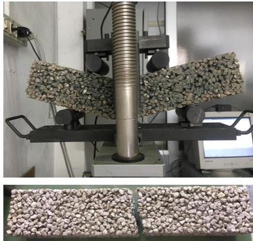
Figura 4-27: Monconi prodotti dalla rottura a flessione del travetto
