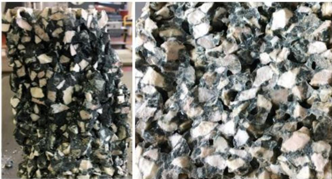
Figura 6-42: Superfici di rottura: a destra campione cilindrico rotto a flessione, a sinistra campione prismatico rotto a flessione su 4 punti. L'aggregato non si sgretola per cedimento della malta ma si spezza sotto effetto del carico di prova, a dimostrazione della bassa resistenza.
