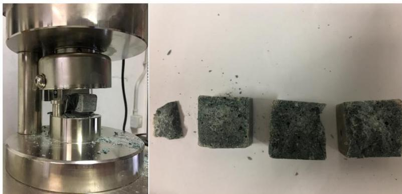
Figura 4-14: Espansione laterale del provino rotto e moncone rotto a compressione
