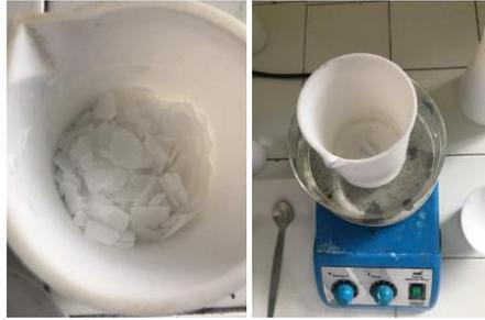
*Figura 3-3: A destra scaglie di soda caustica, a sinistra becker su agitatore magnetico*
