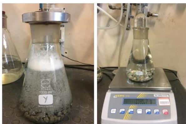
Figura 4-23: Picnometro in fase di deaerazione e pesatura finale
