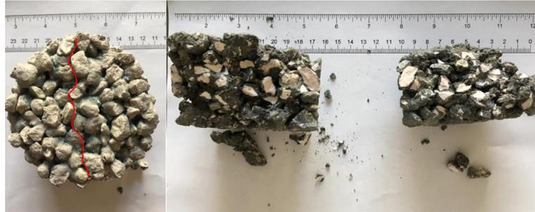
Figura 4-4: Campione rotto alla prova di trazione indiretta
