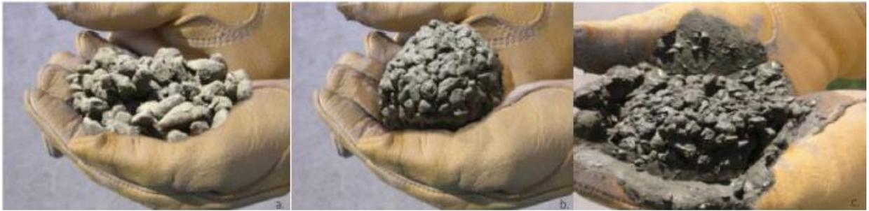
Figura 1-9: Valutazione visiva della consistenza della miscela fresca di un calcestruzzo poroso: (a) eccesso di fase legante, (b) consistenza ottimale, (c) miscela sciola (Tennis, 2004)
