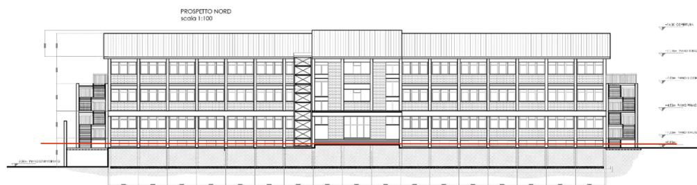
**Figura 7.46:** Prospetto edificio con la quota dell’isolamento
