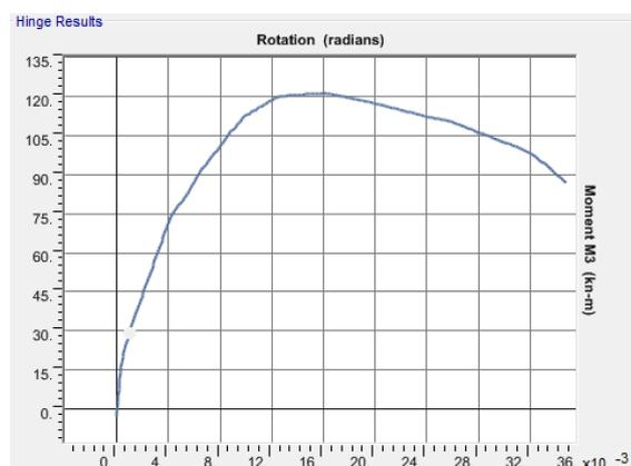
**Figura 7.28:** Momento curvatura della trave di tipo 4 all'aumentare della forza applicata
