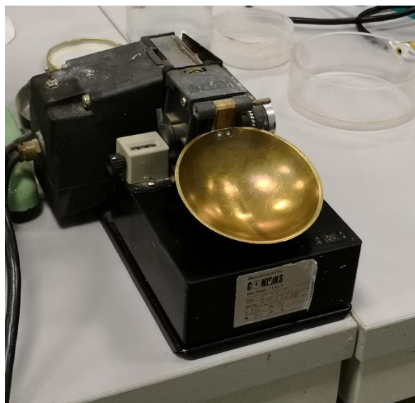
Figura 3-1 Cucchiaino di Casagrande
