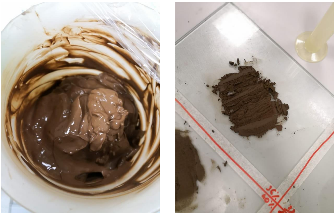
Figura 4-2 Differenti consistenze tra le miscele Bentonite-Acqua (sinistra) e Bentonite-Olio (destra)
