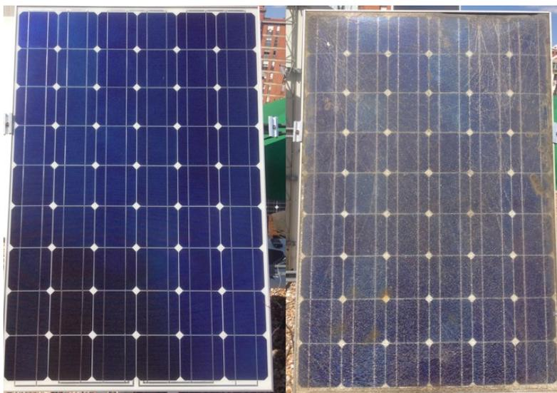
**Figura 21:** esempio di due moduli dello stesso modello in p-Si nuovo (sinistra) e a fine vita (destra)
