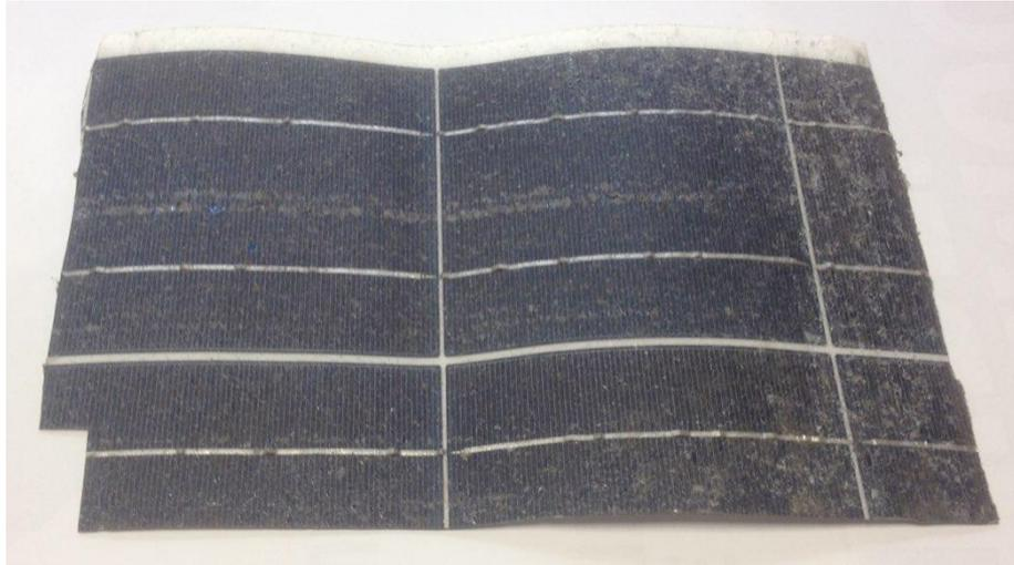
**Figura 52:** provino di sandwich privato del vetro fornito da SASIL per le sperimentazioni
