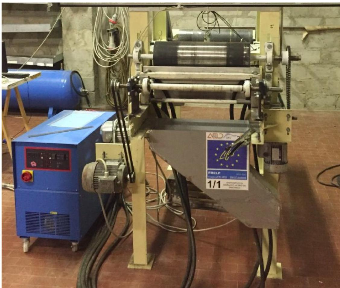
*Figura 38: foto del prototipo per il distacco del vetro realizzato da SASIL*
