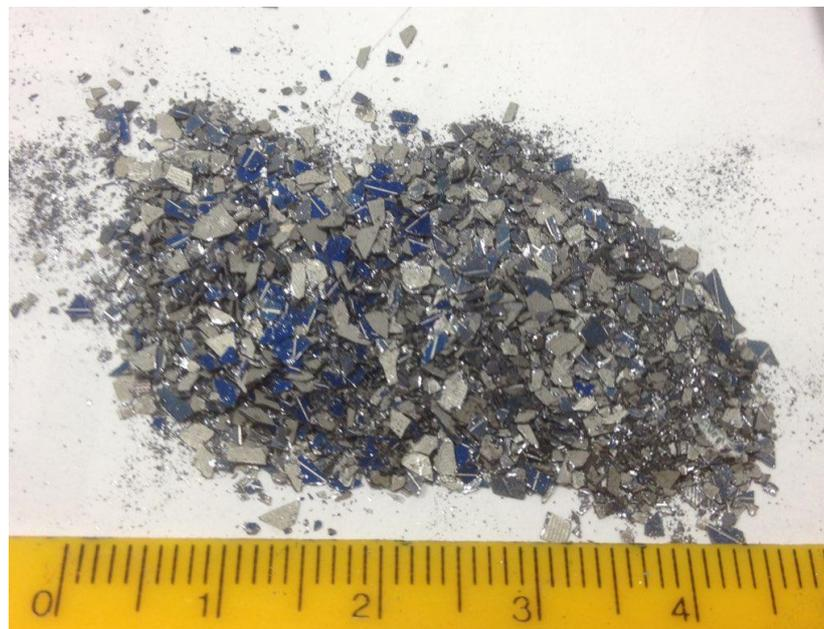
*Figura 57: frammenti di wafer ricavato dal distacco manuale del sandwich e utilizzato per i test*
