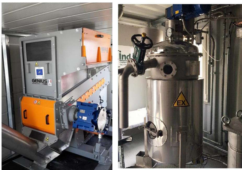
*Figura 28: trituratore e reattore per il trattamento fisico [58]*
