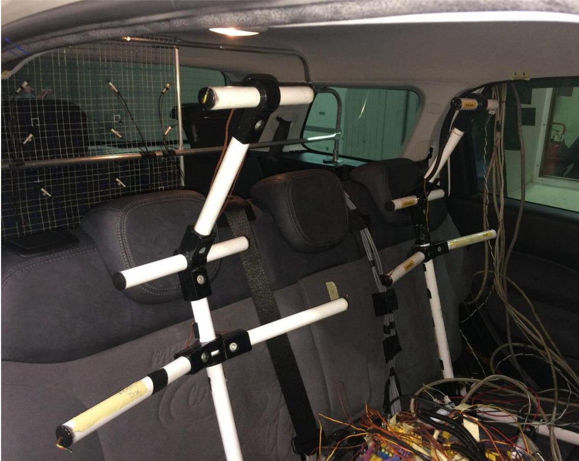
*Figura 104: In primo piano: strumentazione della seconda fila di sedili (due manichini ciascuno dotato di 8 termocoppie). In secondo piano: la griglia della terza fila di sedili allestita con 10 anemometri a filo caldo e 4 termocoppie*
