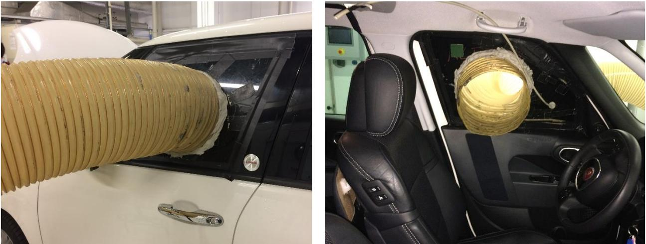
Figura 99: Prove di portata. Determinazione della curva di pressurizzazione immettendo in abitacolo portate d'aria note
