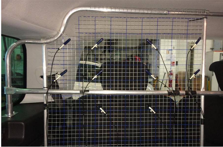
Figura 81: Griglia della terza fila di sedili allestita con 10 anemometri a filo caldo
