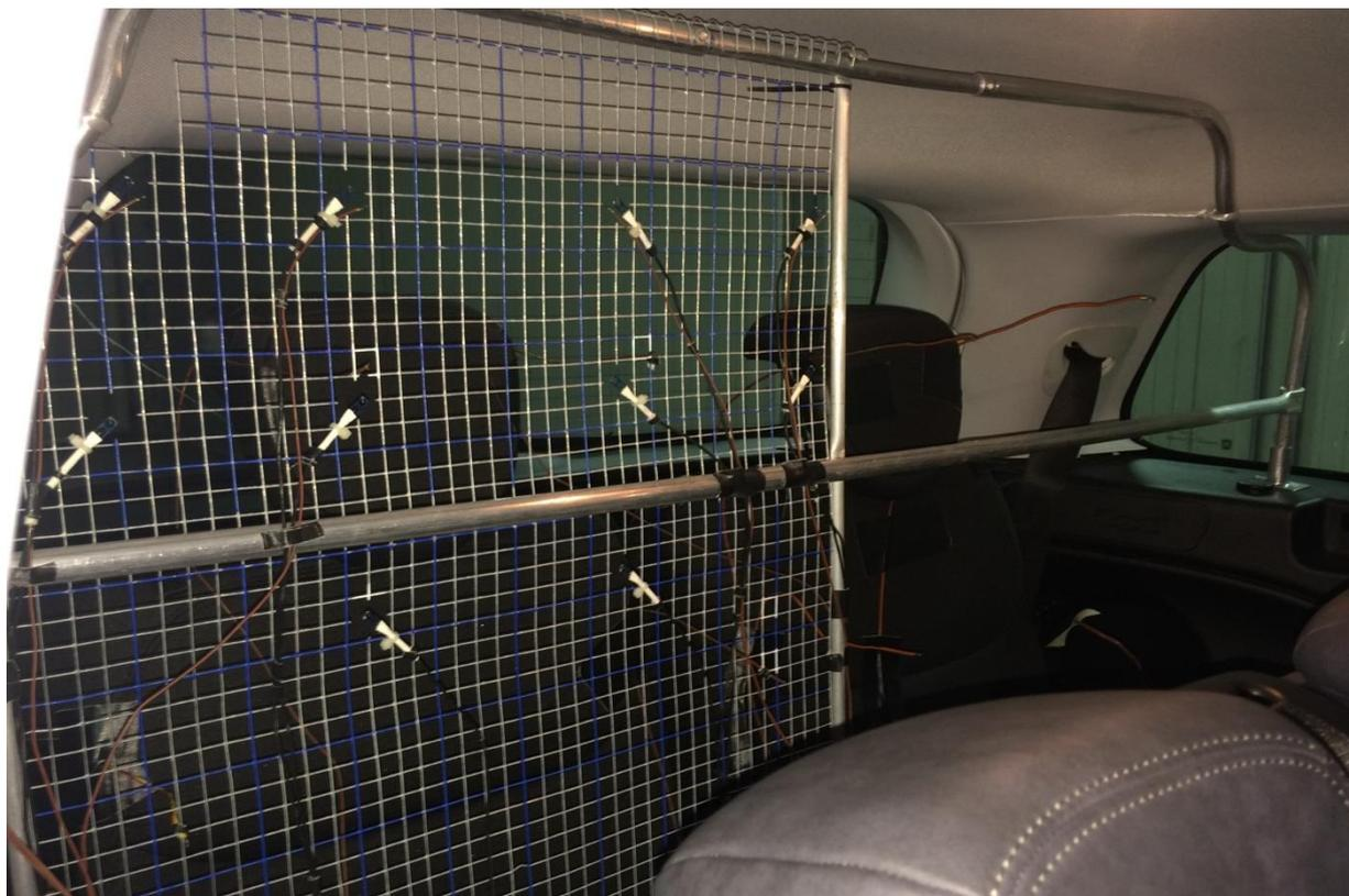
*Figura 108: Griglia della terza fila di Sedili dotata di 10 anemometri a filo caldo e 4 termocoppie*
