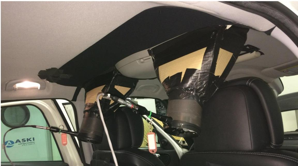
*Figura 102: strumentazione utilizzata per misurare la portata primaria trattata dal Roof Circulator. Si utilizzano Condotti a sezione di uscita costante disposti in prossimità delle fessure di uscita dell'aria. si utilizzano anemometri a ventolino per misurare le velocità*
