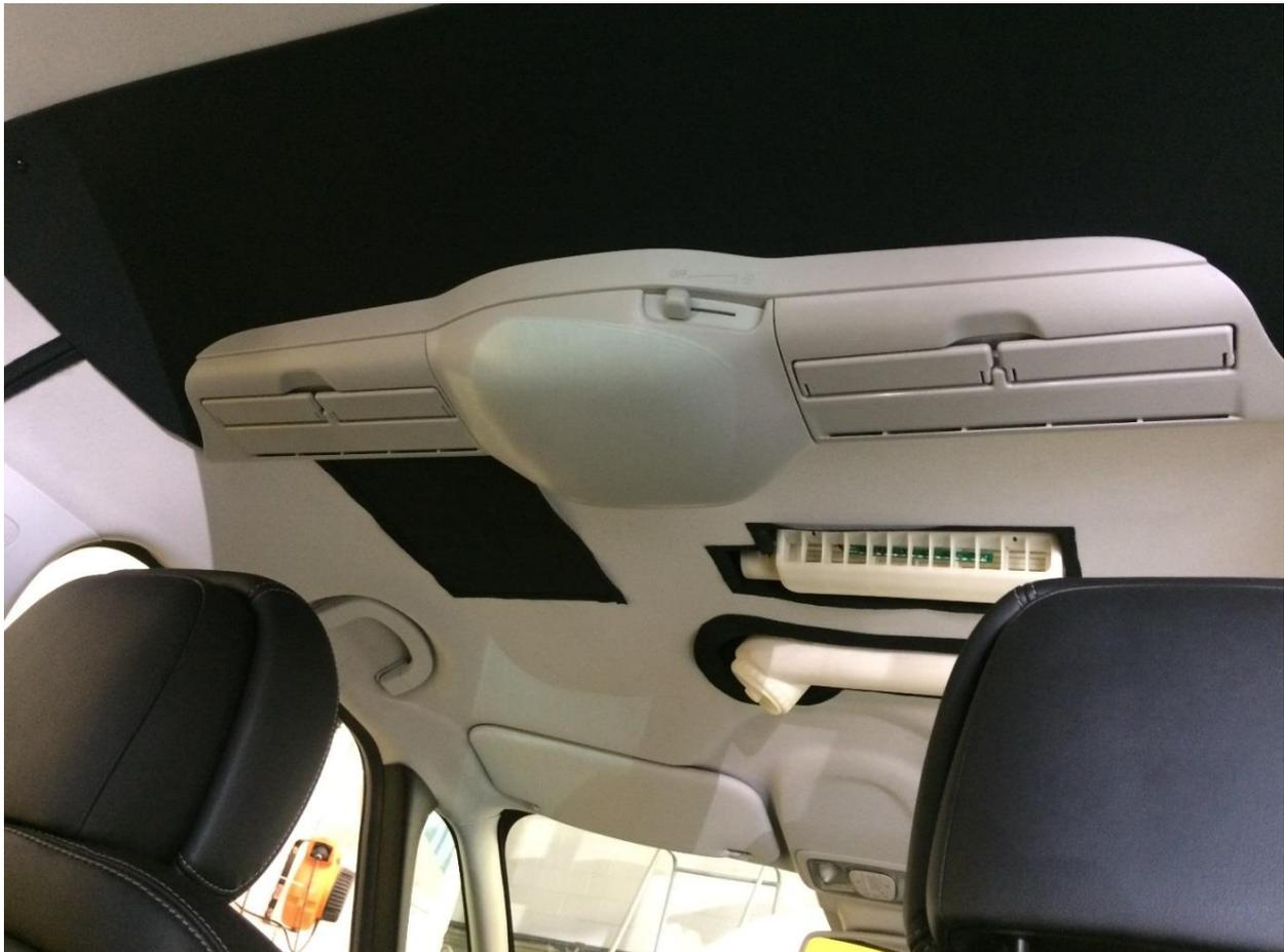
Figura 35: Roof Circulator fissato all'imperiale della vettura
