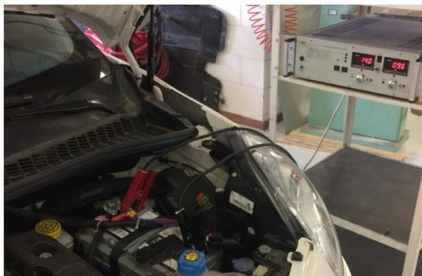
*Figura 46: alimentazione del veicolo tramite alimentatore esterno*
