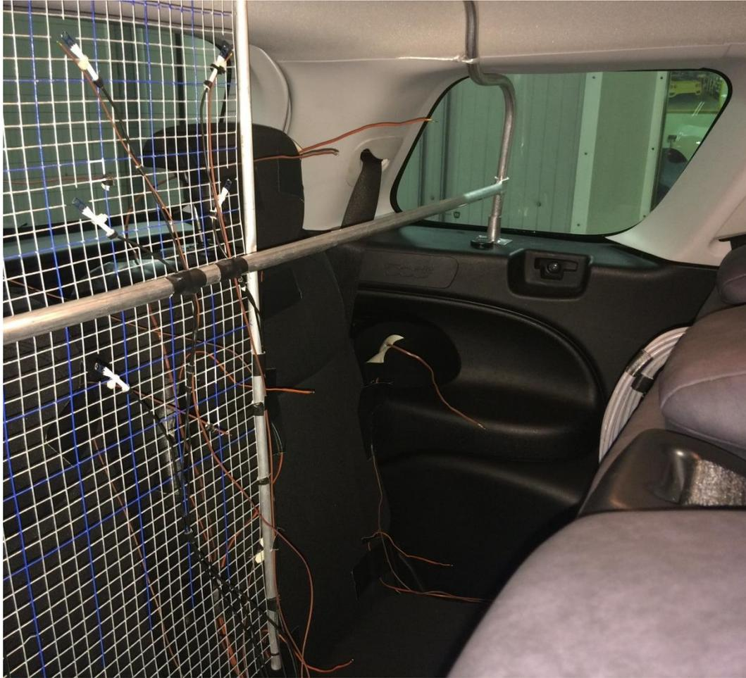
*Figura 107: Strumentazione della terza fila di Sedili.*
