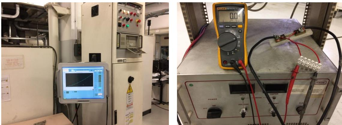
Figura 100: A sinistra alimentatore primario e schermo di visualizzazione. A destra: alimentatore secondario, tester e shunt
