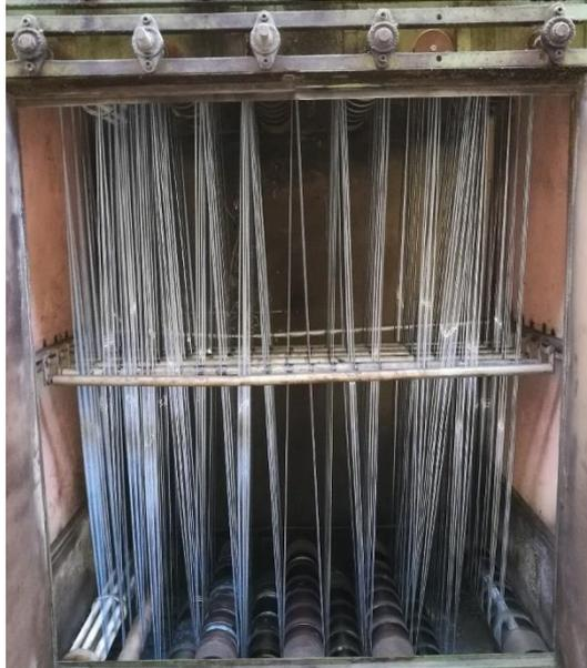
**Figura 2.4** – Vista dell'interno del forno di asciugatura
