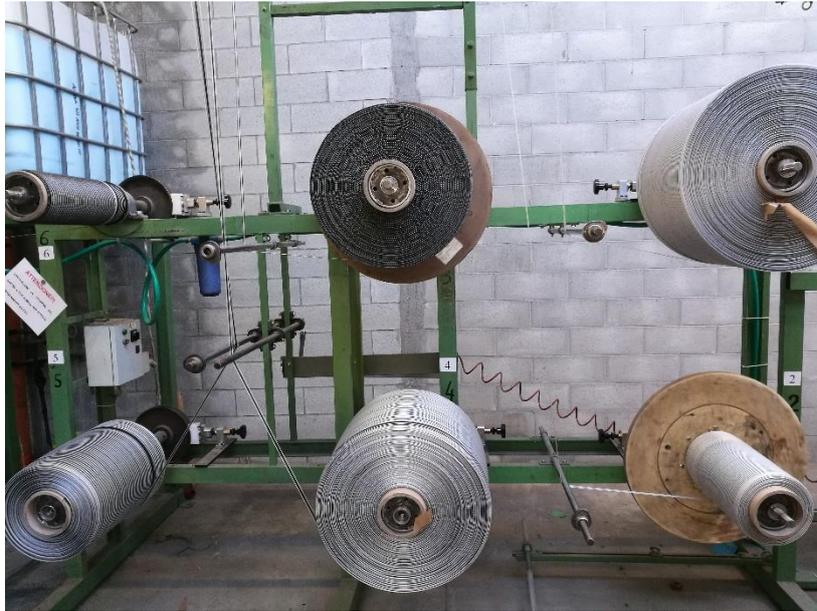
Figura 2.3 – Sistema di svolgitura delle 6 bobine
