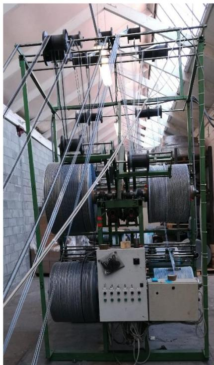
**Figura 2.5** – Sistema tira pezza di riavvolgitura del nastro
