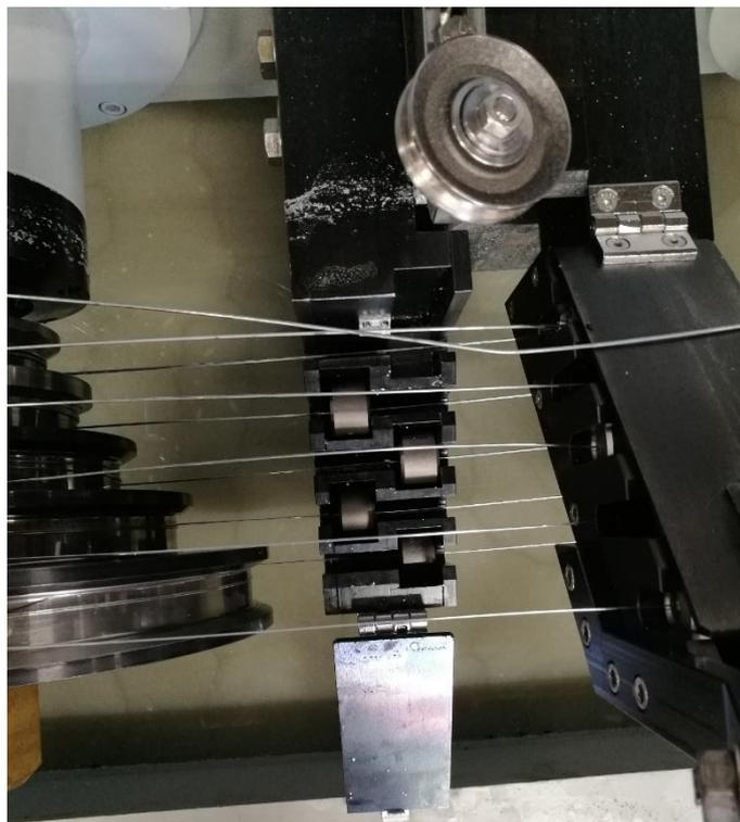
**Figura 2.7** – Vista dei passaggi del filo nelle filiere immerse nel bagno
