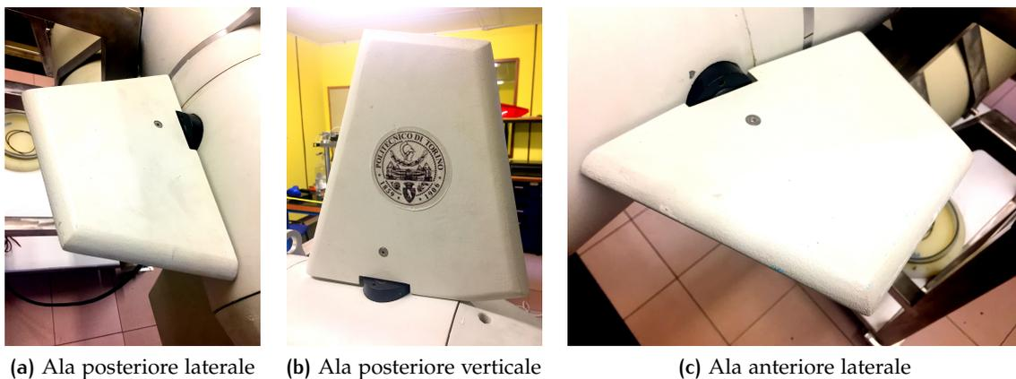
Figura 3.3: Superfici di controllo presenti sull'AUV
