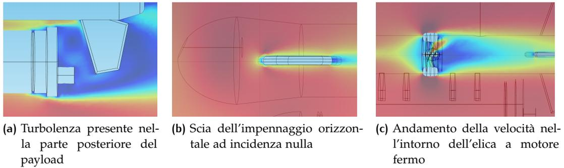
Figura 3.18: Particolari della soluzione in velocità della simulazione IX
