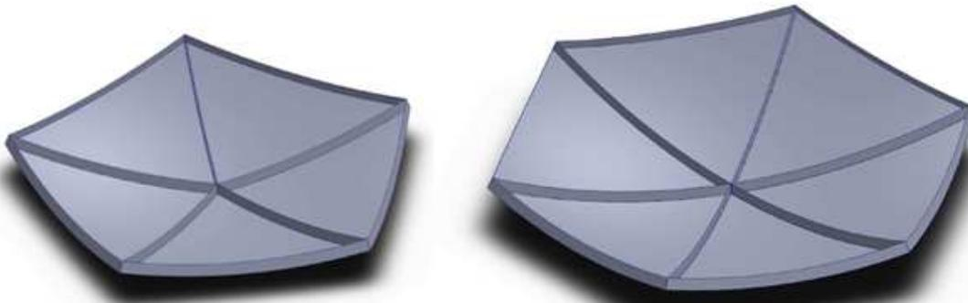
**Figura 5.4: tessere pentagonale ed esagonale costituite dalla superficie sferica esterna, dagli irrigidimenti lungo i bordi e dagli irrigidimenti all'interno**
