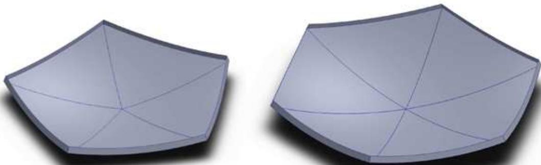
**Figura 5.3: tessere pentagonale ed esagonale costituite dalla superficie sferica esterna e dagli irrigidimenti lungo i bordi**
